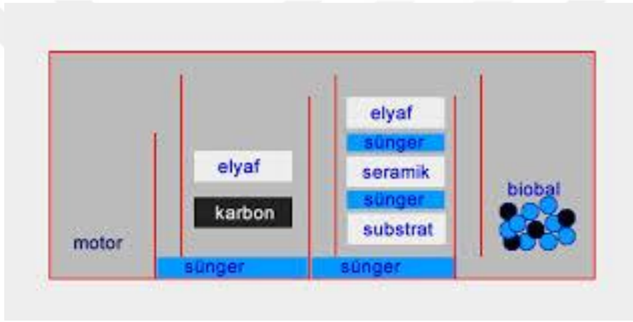
Şekil 6.7 Sump örneği (www.akvaryumportali.com, 2016)
