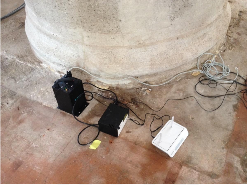
Şekil 5.29 : Fil ayağının yanına yerleştirilen ivmeölçer ve aparatları.
