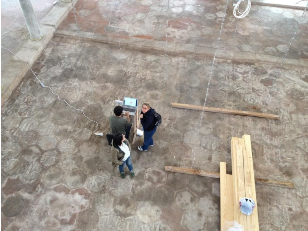
Şekil 5.30 : Ölçüm sırasında, caminin giriş katının ortasında kullanılan bir bilgisayarda ivmeölçerlerden alınan veriler toplanmaktadır.
