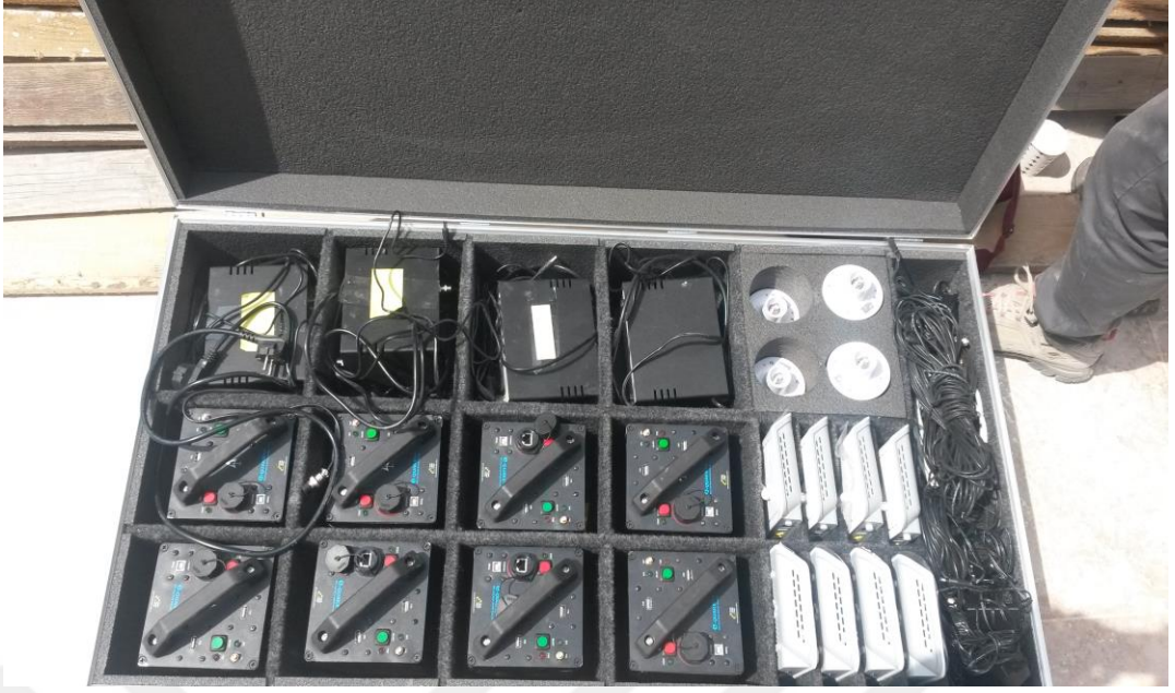
Şekil 5.27 : Ölçümde sırasında kullanılan ivmeölçer, aküleri, wifi üniteleri, Gps aparatı ve kabloları.
