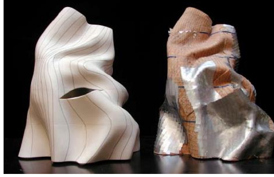
Şekil 3.3 : Sağda Orijinal Maket Solda Taranarak Sayısal Veri ile Üretilen Maket (Shelden, 2002).
