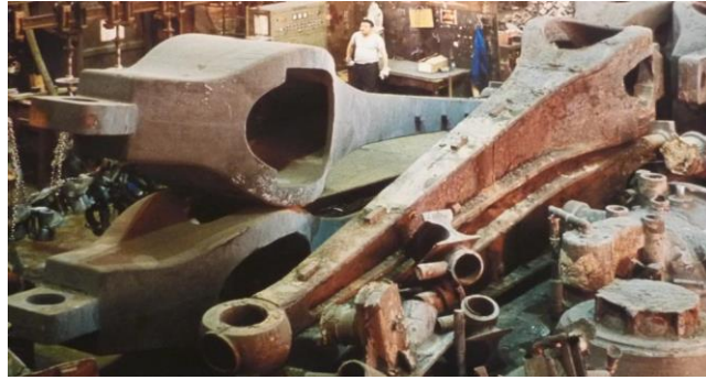
Şekil 2.13 : Dökme Demir Gerberette Elemanlar, (Url-11).
