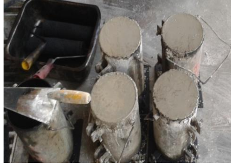
Şekil 3.11. Beton karot numunelerinin alınması
