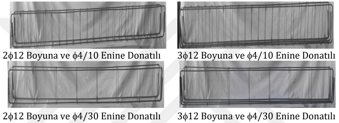
Şekil 3.8. Bir seriye ait üretilen kiriş numunelerinin donatılarının görünüşü
