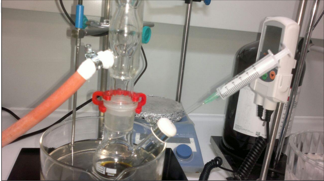
Şekil 3. 18 Hidrazin hidrat'ın şiringadan eklenmesi (2)
