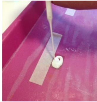
Şekil 3. 59 TiO_2 'in ITO cama uygulanması
