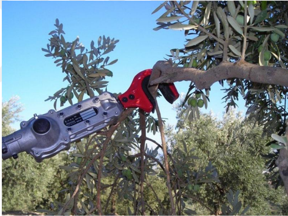
Şekil 4.1. Elde veya Sırtta Taşınabilir Bir Dal Sarsıcısı
