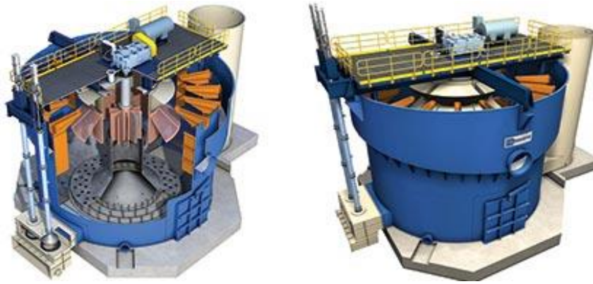
Şekil 1.4 Flotasyon'un Şematik Görünümü (www.flsmidth.com).
