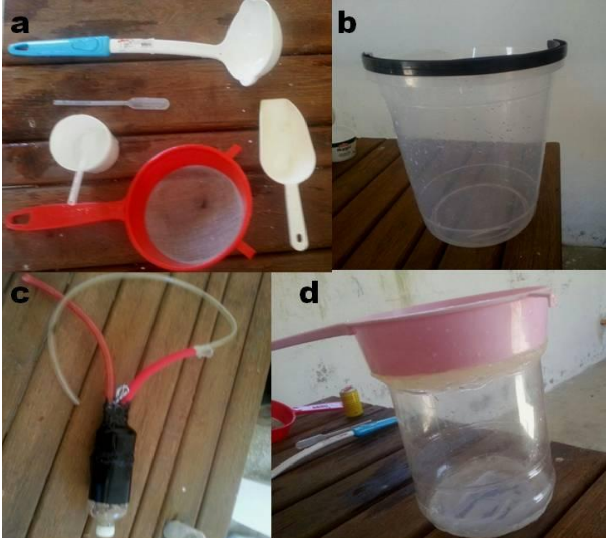
Şekil 3.4. Ünitelerden yumurta, larva ve pupa toplamak amacıyla kullanılan materyaller. a) Numune toplama aletleri; b) Taşıma kabı; c) Aspiratör; d) Süzgeç
