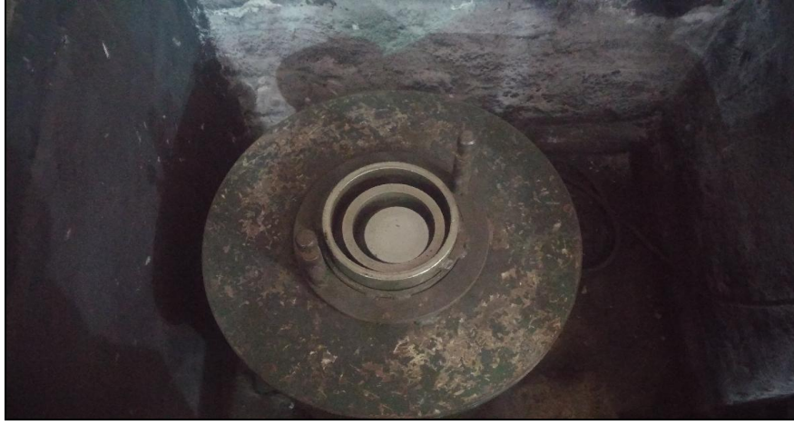
Şekil 4.4. Numune hazırlanırken kullanılan öğütücü
