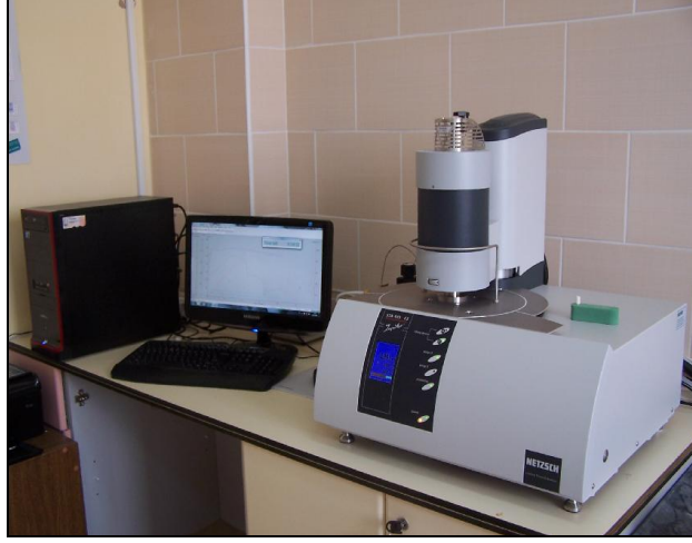
Şekil 4.11. Netzsch marka TGA/DTA analiz cihazı
