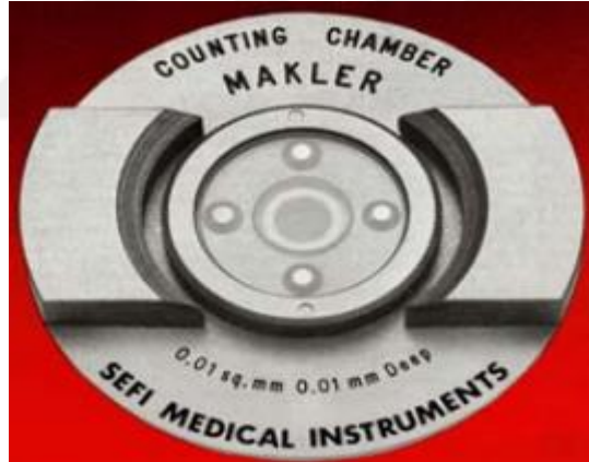
Şekil 20. Makler sperm sayım kamerası 52
