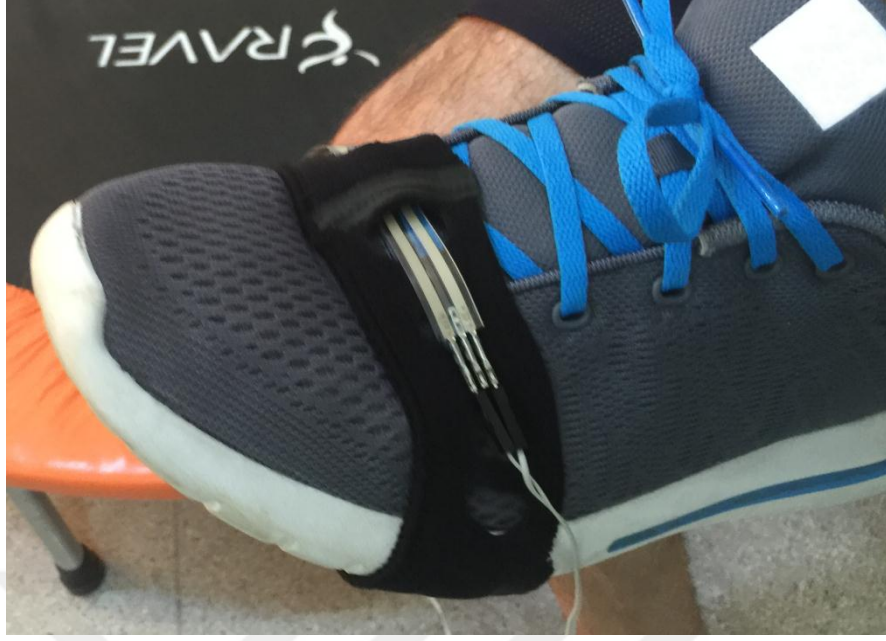
Şekil 7. Neopren bandın içinde ayakkabı altına sabitlenmiş FSR
