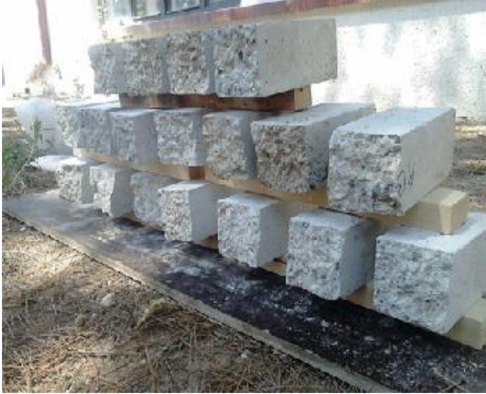
Resim 4.3. Serbest hava ortamında bekletilen beton numuneler
