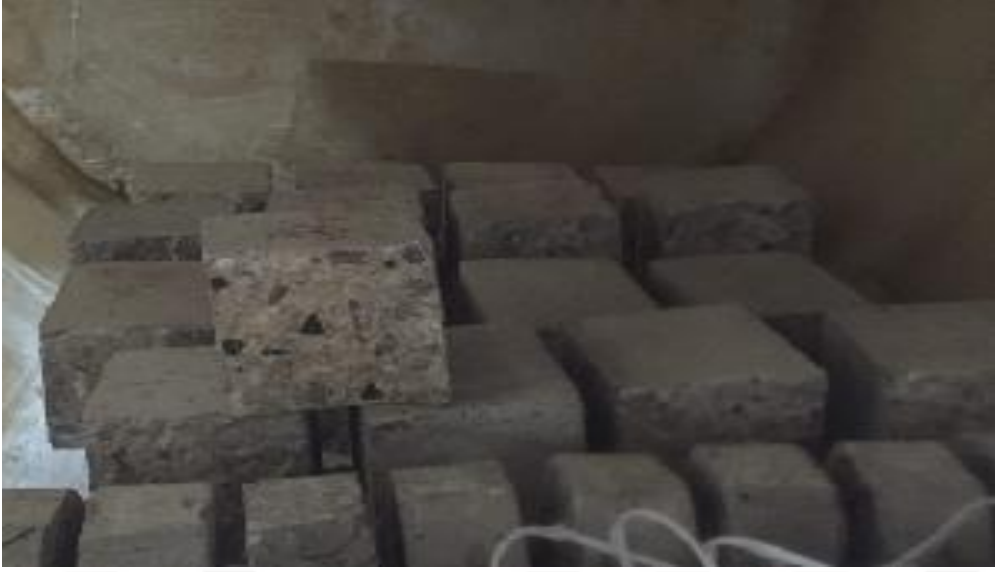
Resim 4.1. CO 2 tankının içindeki beton numuneler
