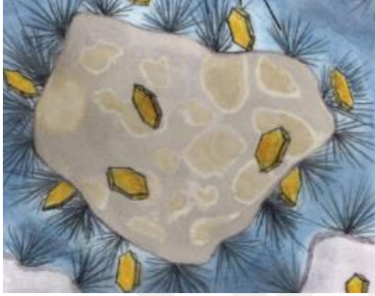
Resim 2.7. Priz zamanında oluşan kristal bağlantılar [22]
