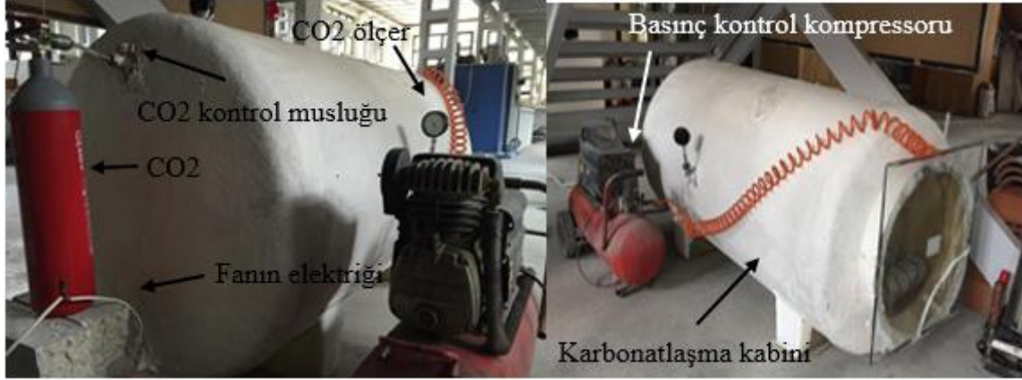
Resim 3.11. Karbonatlaşma tankının bileşenleri
