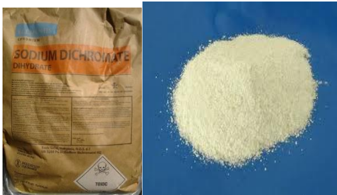
Resim 3.9. Rutubeti kontrol etmek için Sodyum dikromat
