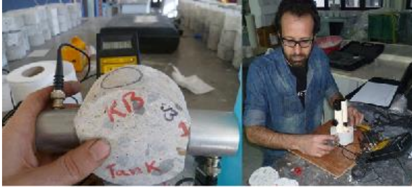
Resim 3.15. Ultrases ve çatlak gösterici deneyin uygulaması
