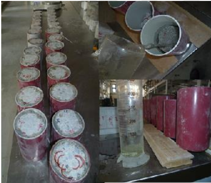
Resim 3.16. Su geçirgenlik deneyin yapılışı
