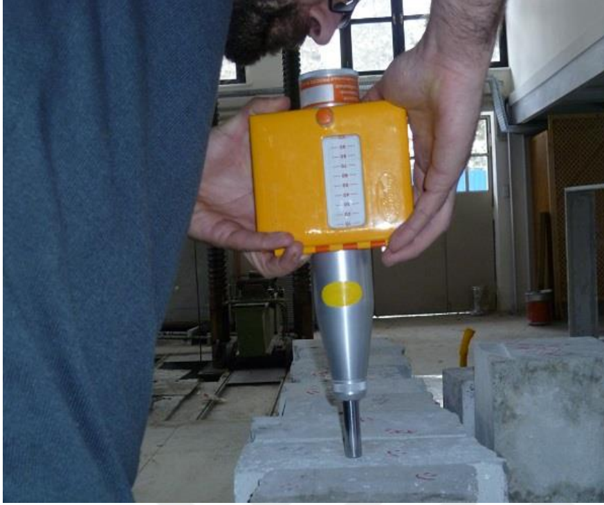
Resim 4.6. Schmidt çekici test yapılması
