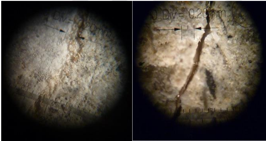
Resim 4.8. Beton numunelerde iyileşmenin 40X büyütmesi
