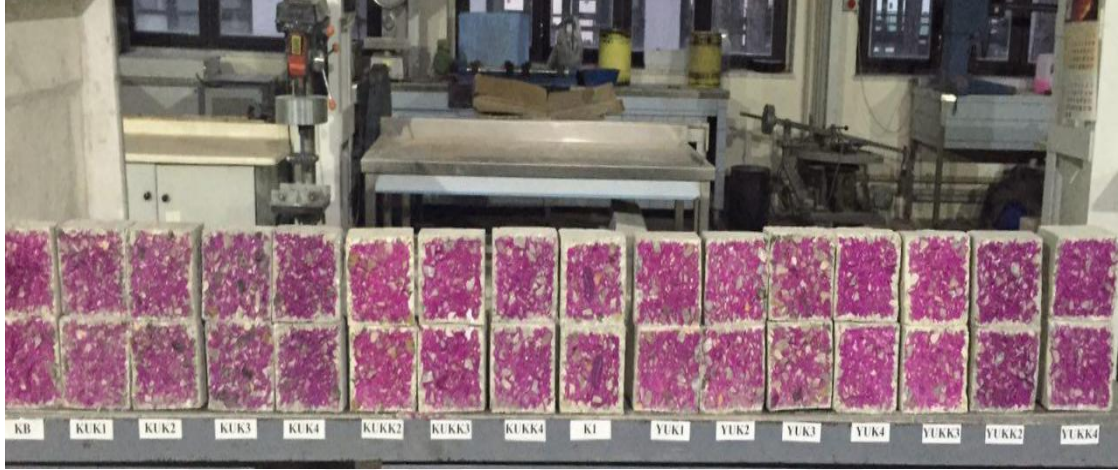
Resim 3.8. Kangal ve Yatağan uçucu küllü beton numunelerin karbonatlaşma hali
