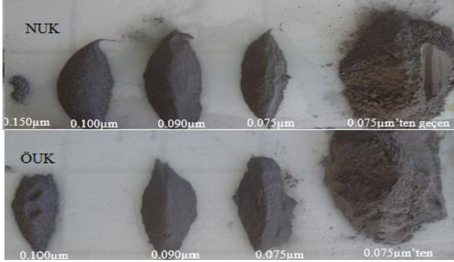
Resim 3.2. Yatağan Ök'ün eleklerle göre tane dağılımı
