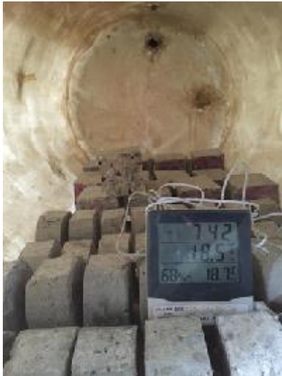
Resim 3.10. Tankın içindeki nem ve sıcaklık miktarını kontrolü
