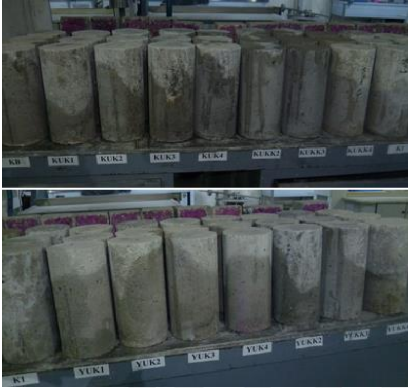
Resim 3.4. Basınç deneyi için hazırlanan YUK ve KUK beton silindir numuneler
