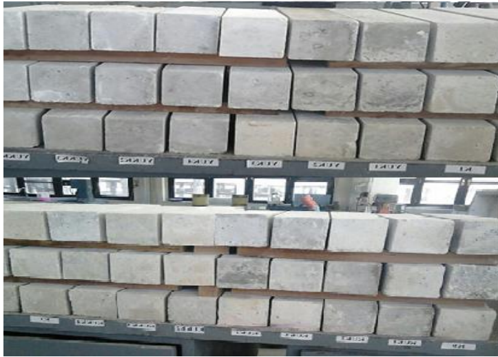
Resim 3.6. Eğilme için hazırlanan Yatağan uçucu küllü beton numuneler
