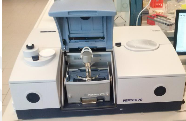
Şekil 3.2 Bruker Vertex 70 FTIR spektroskopisi (Anonymous 2016b)
