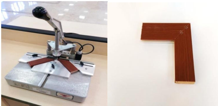
Resim 4.9. Kırılmalıç delik makinesinde H-tipi soket deliđi açma işlemleri
