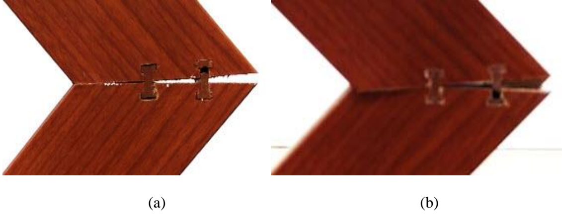
Resim 6.9. H-tipi deney örneği deformasyon tipleri a) MDF kit tutkalı b) Poliüretan tutkalı
