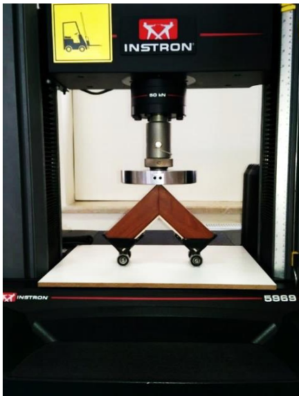
Resim 4.12. Diyagonal çekme deney örneği ve test düzeneği
