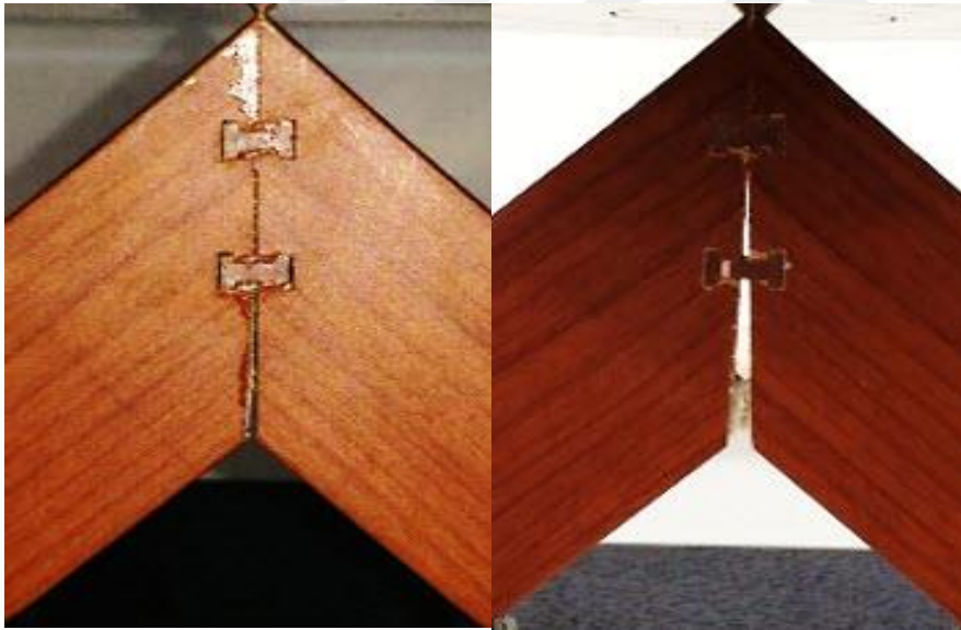
Resim 6.2. Çift kavelalı deney örneği deformasyon tipleri a) MDF kit tutkalı b) Poliüretan tutkalı
