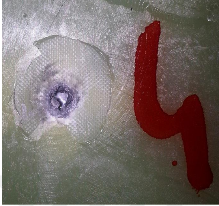
Şekil 3.42 Epoxyglas G10/ FR4 4. atış sonrası önden görünümü Deney sonrası alüminyum ve epoksi kompozit tabakalar birbirlerinden ayrıştırılarak inceleme yapılmıştır. Bu incelemeler sırası ile Şekil 3.43 ve Şekil 3.44’de gösterilmiştir.
