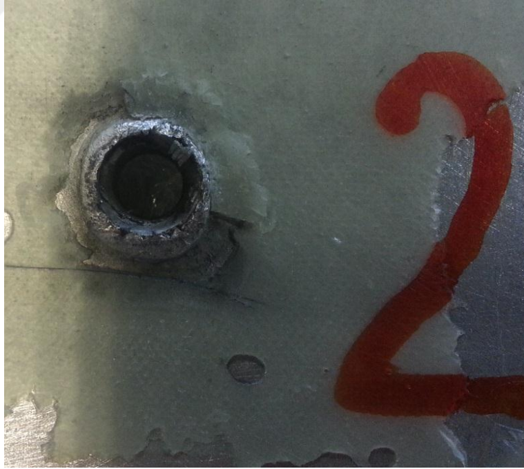
Şekil 3.27 Al6082 T6 levhanın 2. atış sonrası arkadan görünümü
