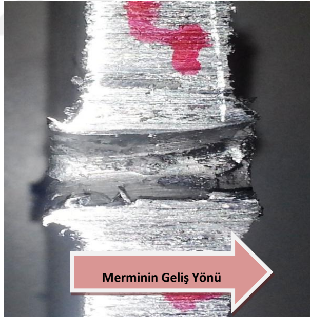
Şekil 3.43 4. atış sonrası Al6082 T6 kesit görünümü
