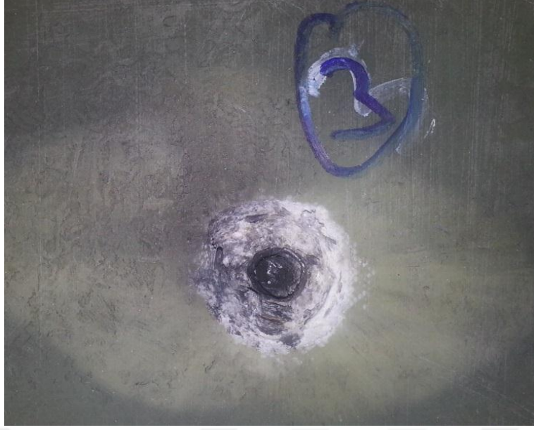
Şekil 3.33 A zırh malzemesi 3. atış sonrası arkadan görünümü Deney sonrası zırh malzemesi üzerine yapılan inceleme sonrası AA-6082 T6 arka görünümü Şekil 3.34'de ve Epoxyglas G10/ FR4 malzemenin önden görünümü ise Şekil 3.35'de verilmiştir.
