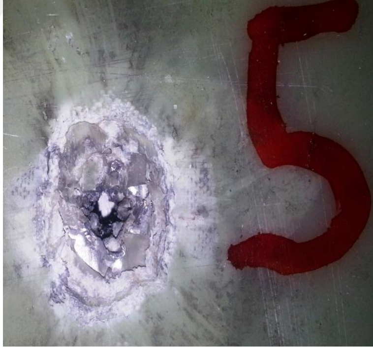
Şekil 3.50 B zırh malzemesi 5. atış sonrası arkadan görünümü
