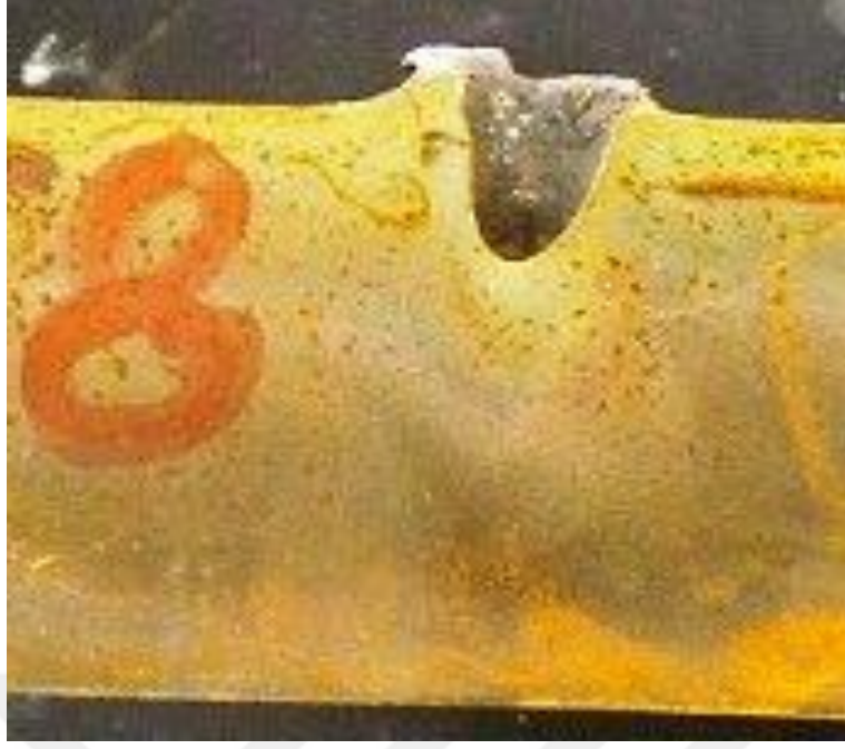
Şekil 3.64 8. atış sonrası referans malzemedeki nüfuziyetin kesit görünümü
