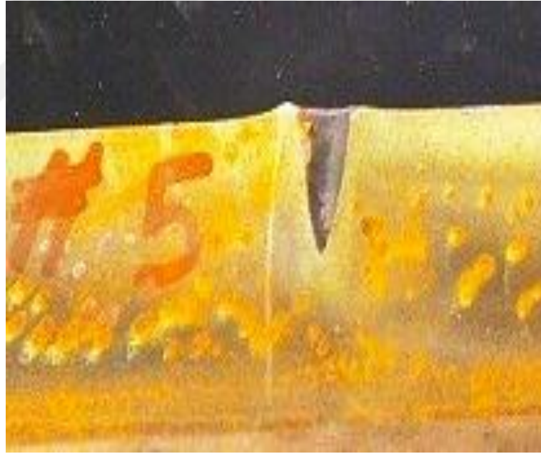
Şekil 3.52 5. atış sonrası referans malzemedeki nüfuziyetin kesit görünümü.
