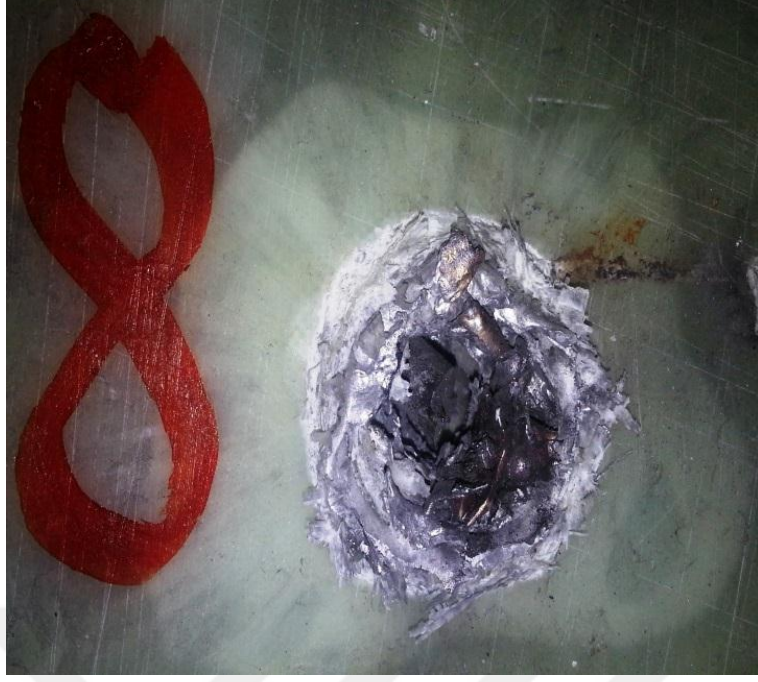
Şekil 3.62 B zırh malzemesi 8. atış sonrası arkadan görünümü
