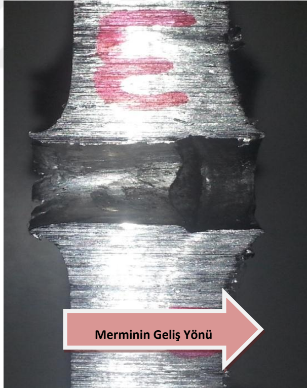
Şekil 3.36 3. atış sonrası AA-6082 T6 kesit görünümü
