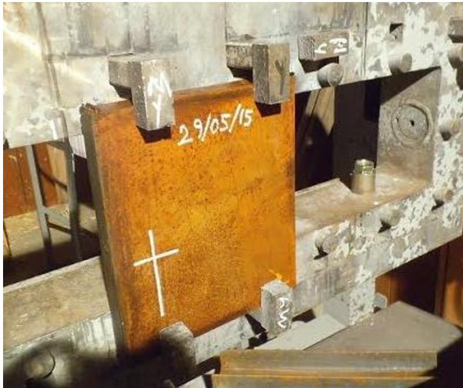
Şekil 3.14 RHA şahit numune çeliğin atış öncesi görünümü
