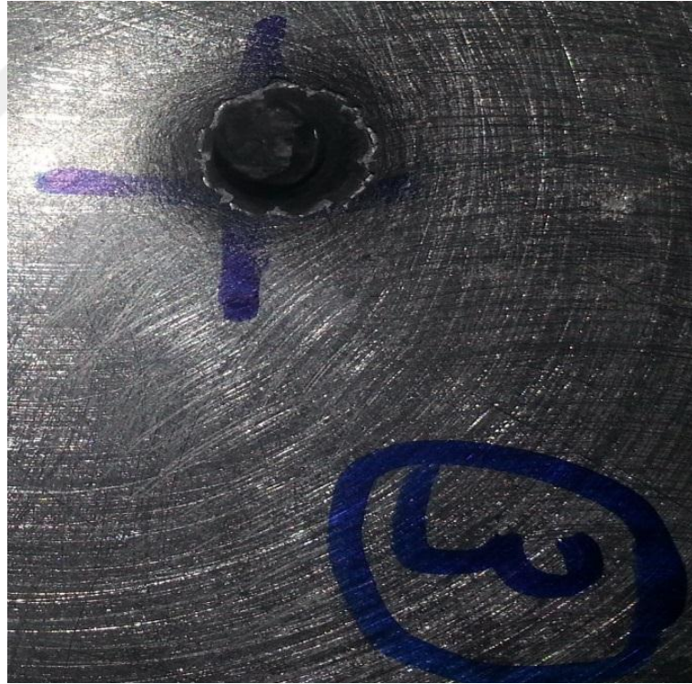
Şekil 3.32 A zırh malzemesi 3. atış sonrası önden görünümü
