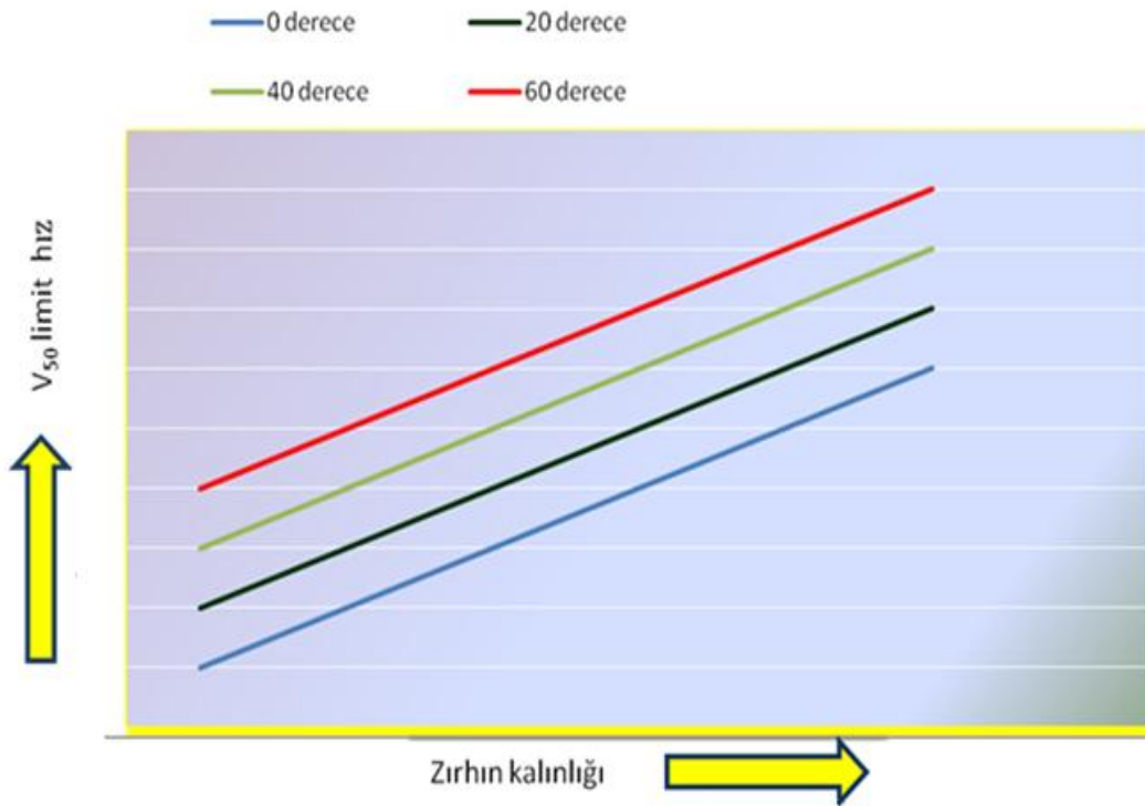
Şekil 2.16 Alařımların V_{50} hızında çarpma açılarına göre karşılaştırılması [14]
