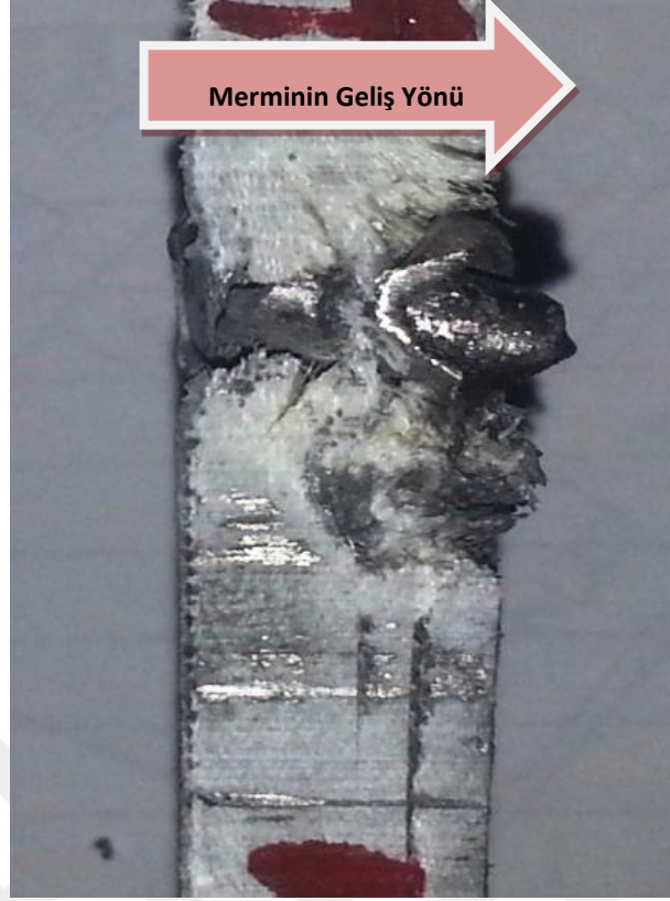
Şekil 3.37 3. atış sonrası Epoxyglas G10/ FR4 kesit görünümü RHA referans malzemenin delinme şekli ve derinliğinin resmi Şekil 3.38'de verilmiştir.
