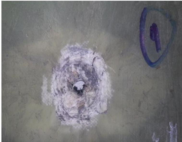
Şekil 3.19 A zırh malzemesi 1. atış sonrası arkadan görünümü
