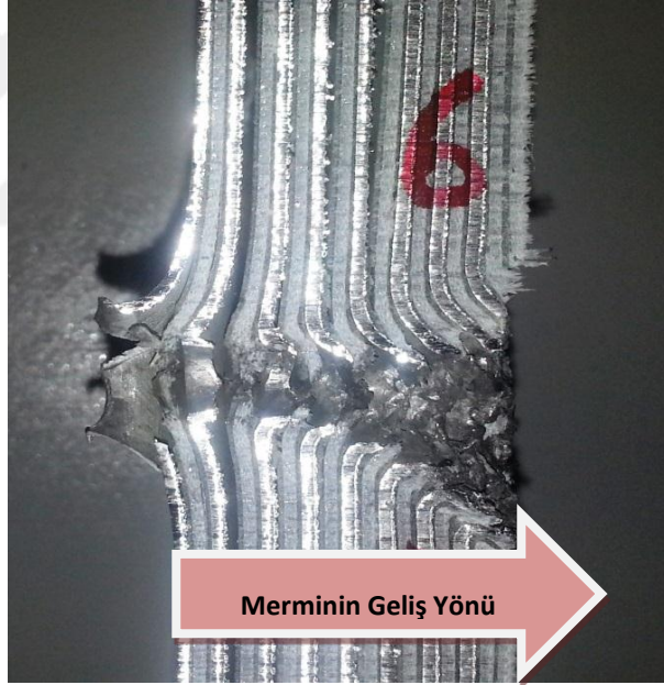
Şekil 3.55 B zırh malzemesi 6. atış sonrası kesit görünümü
