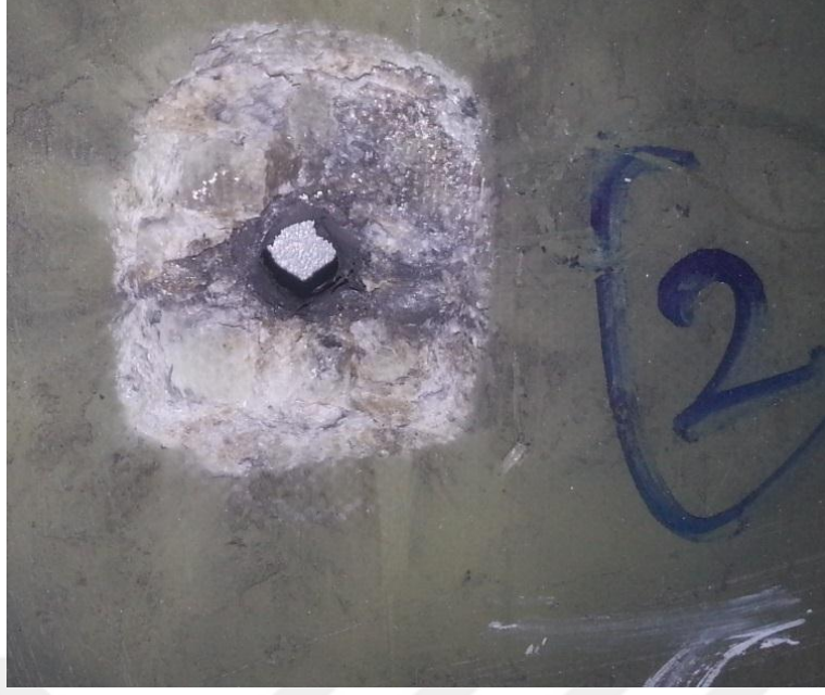
Şekil 3.26 A zırh malzemesi 2. atış sonrası arkadan görünümü
