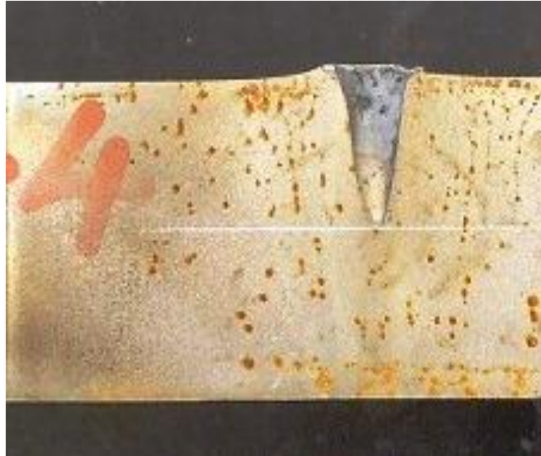
Şekil 3.45 4. atış sonrası referans malzemedeki nüfuziyetin kesit görünümü A zırh malzemesi üzerine yapılan 4. atış sonucunda;
