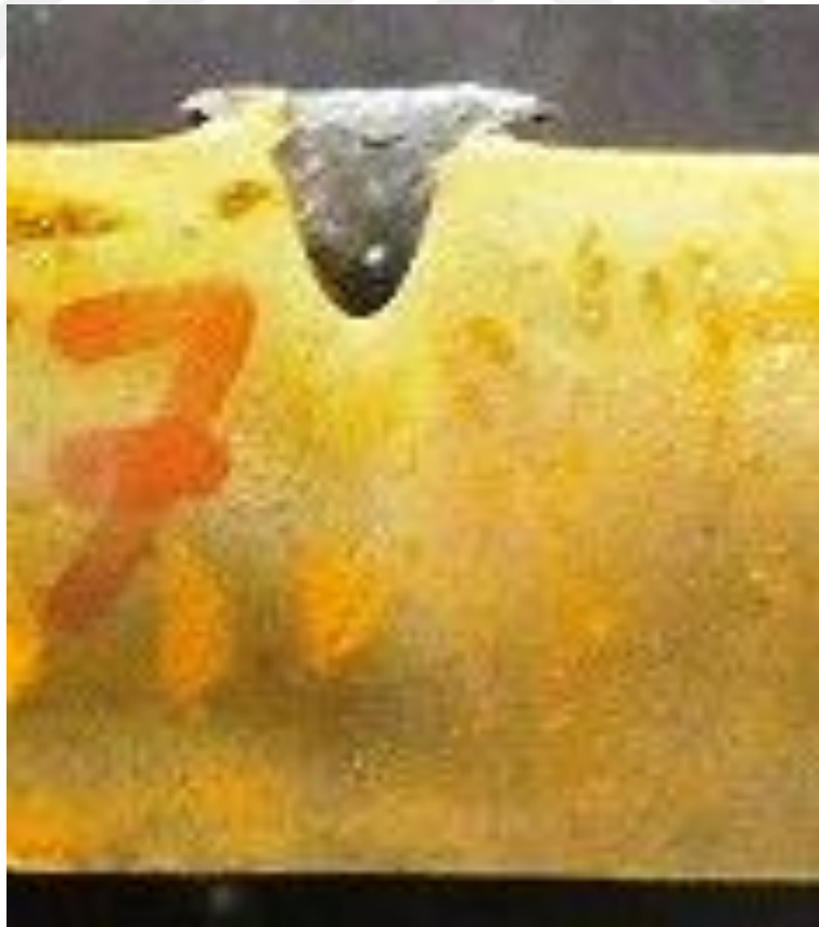
řekil 3.60 7. atıř sonrası referans malzemedeki nüfuziyetin kesit görünümü
