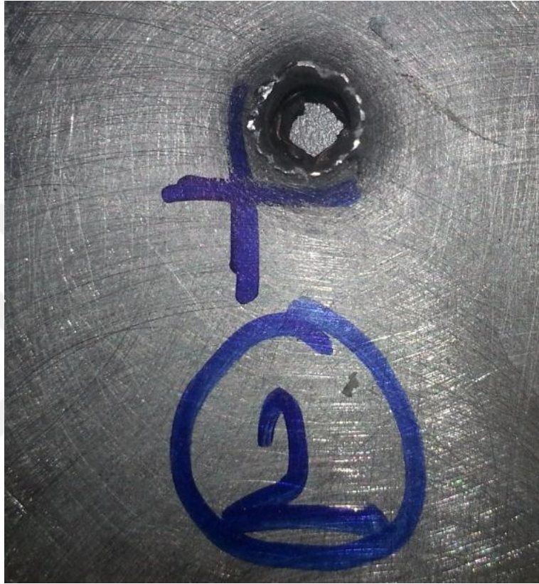
Şekil 3.25 A zırh malzemesi 2. atış sonrası ön görünümü
