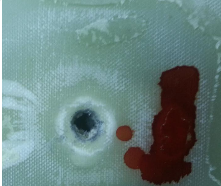
Şekil 3.21 Epoxyglas G10/ FR4 1. atış sonrası önden görünümü
