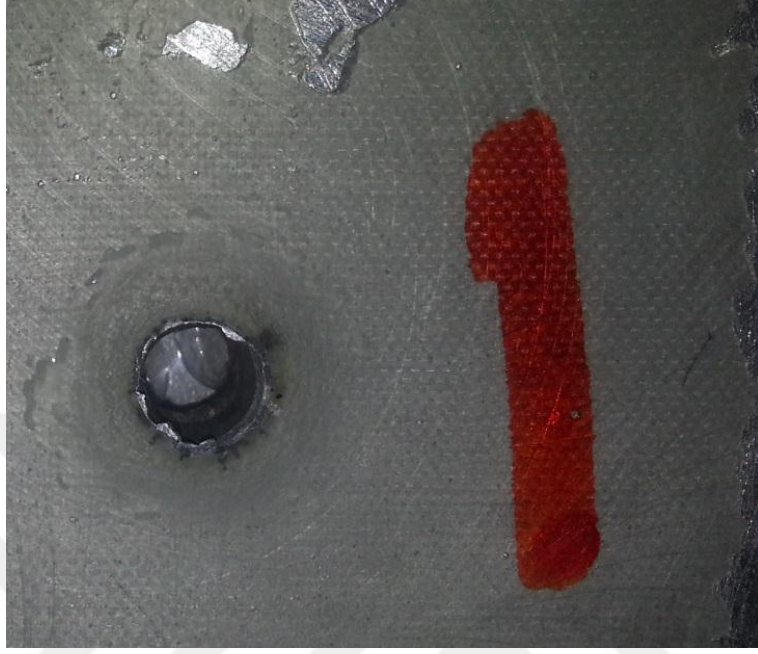
Şekil 3.20 Al6082 T6 levhanın 1. atış sonrası arkadan görünümü
