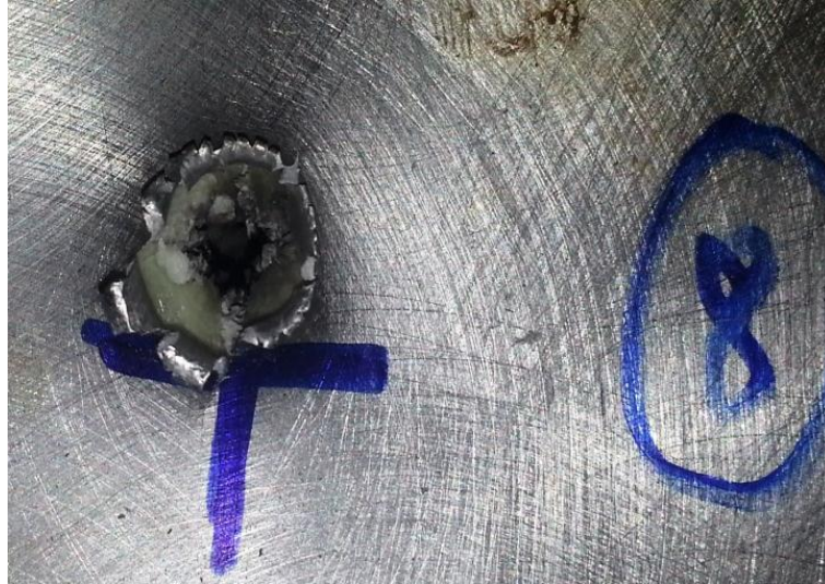
Şekil 3.61 B zırh malzemesi 8. atış sonrası önden görünümü
