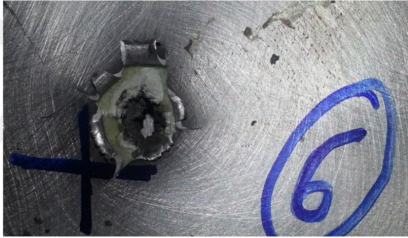
Şekil 3.53 B zırh malzemesi 6. atış sonrası önden görünümü
