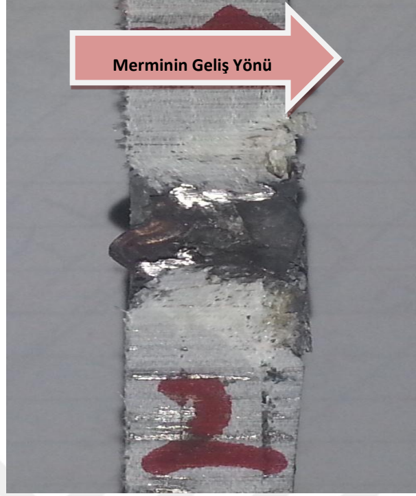
Şekil 3.30 2. atış sonrası Epoxyglas G10/ FR4 kesit görünümü
