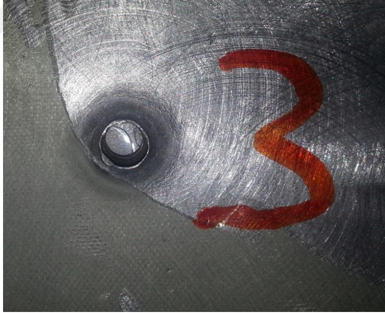
Şekil 3.34 Al6082 T6 levhanın 3. atış sonrası arkadan görünümü
