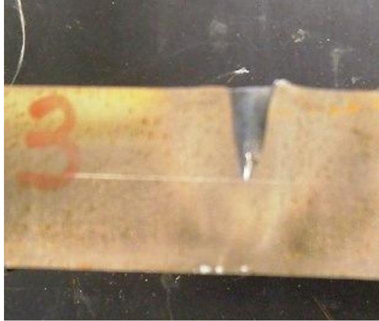
Şekil 3.38 3. atış sonrası referans malzemedeki nüfuziyetin kesit görünümü
