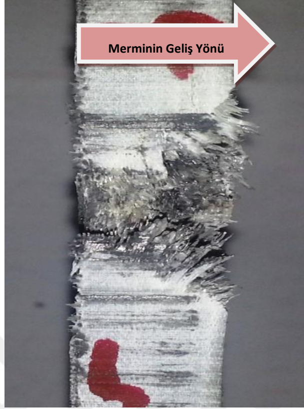
Şekil 3.44 4. atış sonrası Epoxyglas G10/ FR4 kesit görünümü RHA referans malzemenin delinme şekli ve derinliğinin kesit görünümü Şekil 3.45'de verilmiştir.
