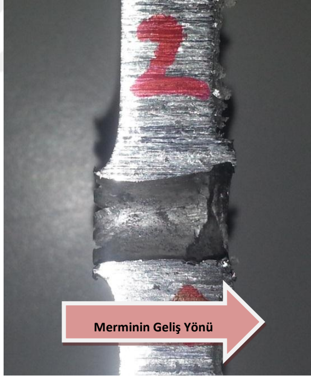
Şekil 3.29 2. atış sonrası Al6082 T6 kesit görünümü
