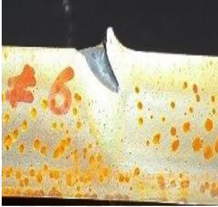
Şekil 3.56 6. atış sonrası referans malzemedeki nüfuziyetin kesit görünümü.
