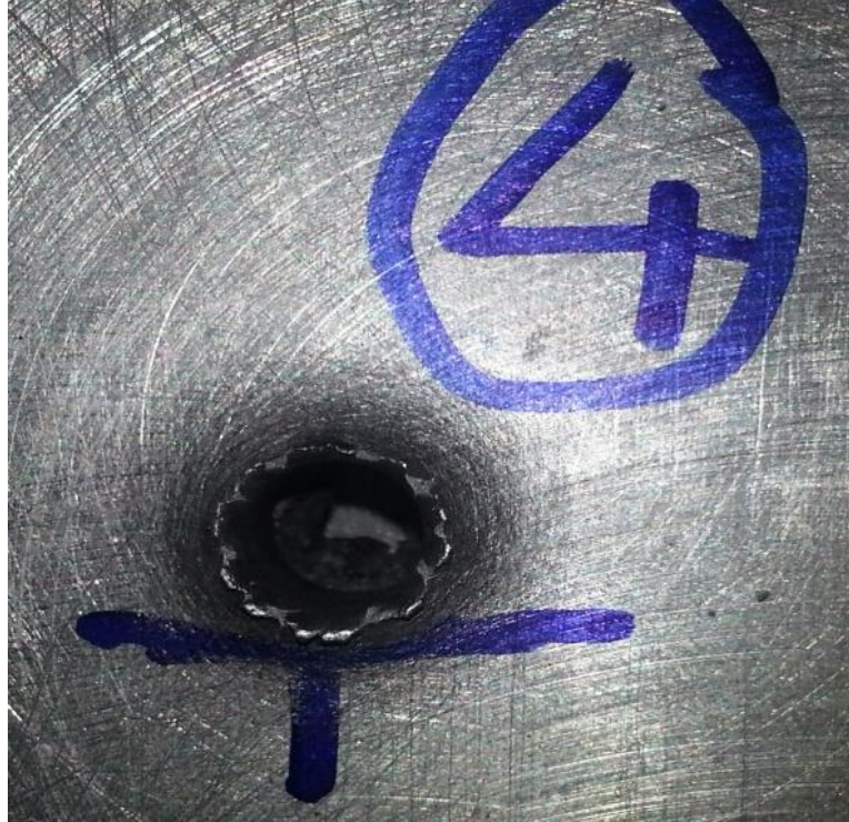
Şekil 3.39 A zırh malzemesi 4. atış sonrası önden görünümü
