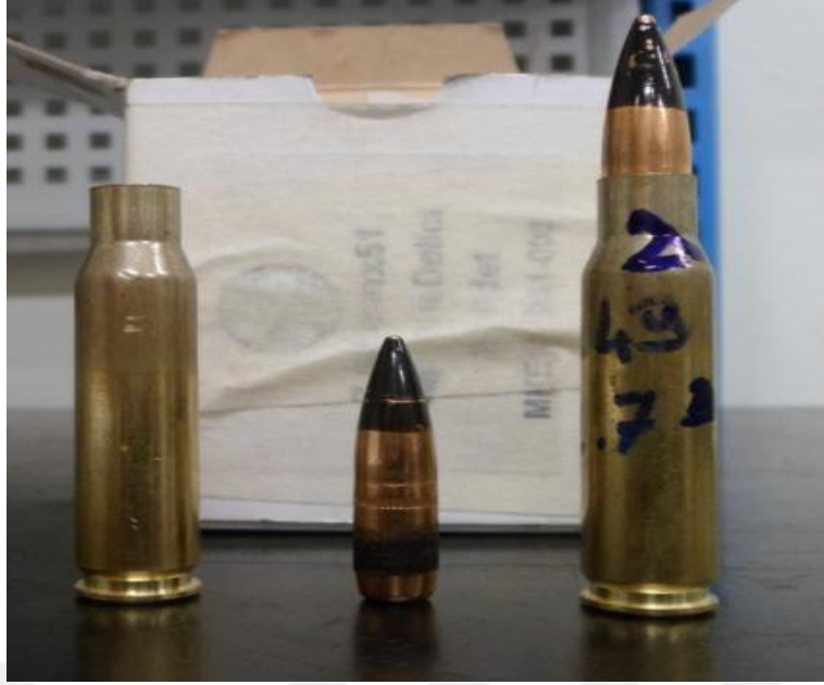
Şekil 3.8 AP 7,62x51 MKE veya 7,62mmx51 (M61) zırh delici fişek mermisi [29]
