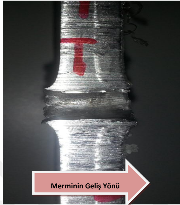
Şekil 3.22 1. atış sonrası AA-6082 T6 kesit görünümü
