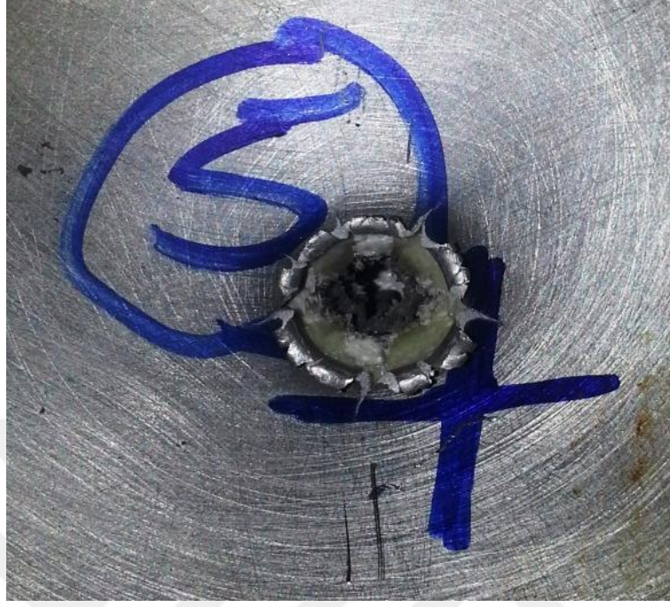
Şekil 3.49 B zırh malzemesi 5. atış sonrası önden görünümü
