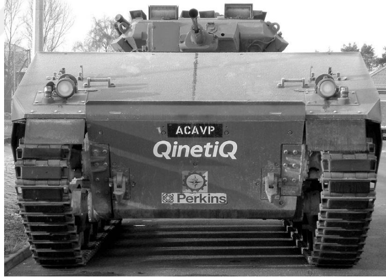
Şekil 2.23 Cam fiber- epoksi matrisli gövdenin görünümü [12]
