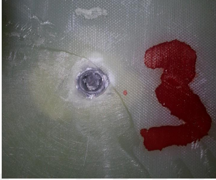
Şekil 3.35 Epoxyglas G10/ FR4 3. atış sonrası önden görünümü
