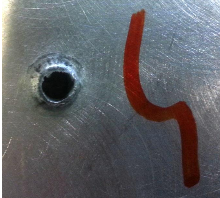
Şekil 3.41 Al6082 T6 levhanın 4. atış sonrası arkadan görünümü
