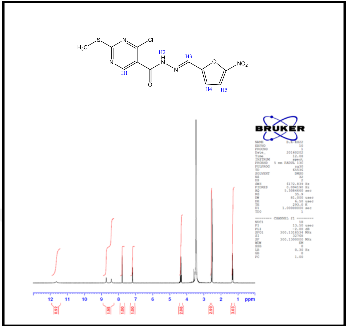
Şekil 87: Bileşik 2t'nin ^1\text{H} -NMR spektrumu
