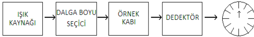
Şekil 1.5. Bir spektrofotometrenin temel bileşenleri
