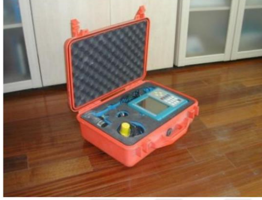
Şekil 3.4 : Kazık Süreklilik Testi Cihazı [13].
