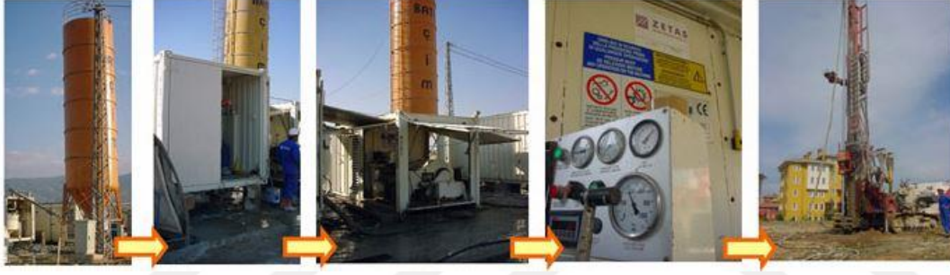
Şekil 2.13 : Jet grout silo – pompa – ve karıştırıcı üniteleri [11].
