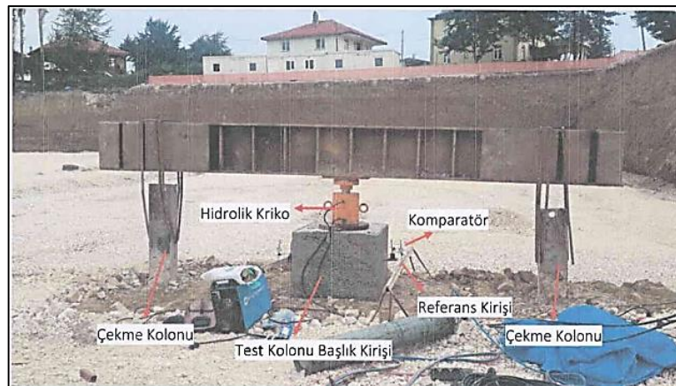
Şekil 4.13 : Sahada uygulanan yükleme testi düzeni [19]
