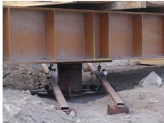
Şekil 3.2 : Kazık yükleme testi [13].
