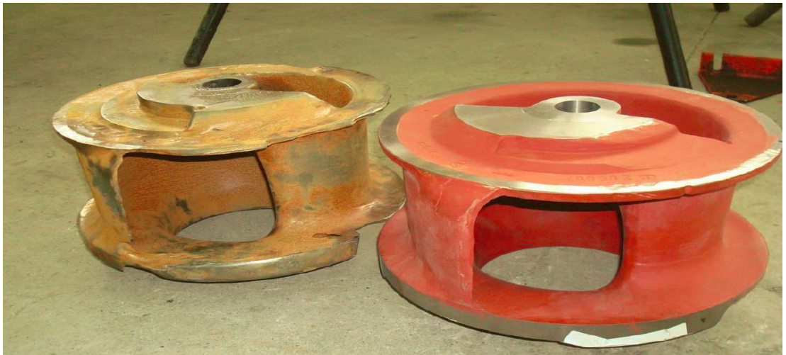
Şekil 4.11: Metal yüzeyde oluşan korozyon.
