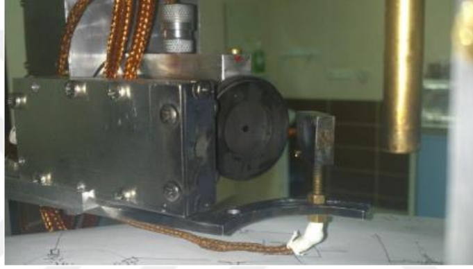
Şekil 3.8 Faraday Elektron toplayıcısı üzerine yerleştirilen küçük boyuttaki FET' in fotoğrafı.
