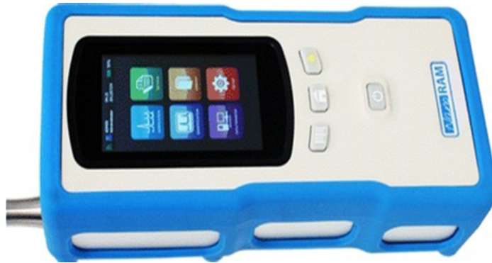
Resim 2.2. NanoRam® elde taşınabilir Raman spektrometresi [128]
