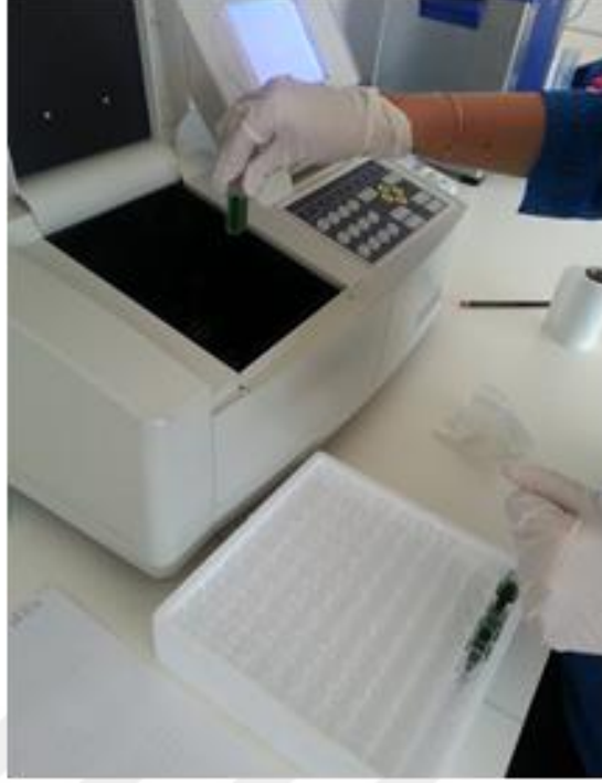
Şekil 3.5. Spektrofotometrede optik yoğunluğun ölçülmesi (Orijinal)
