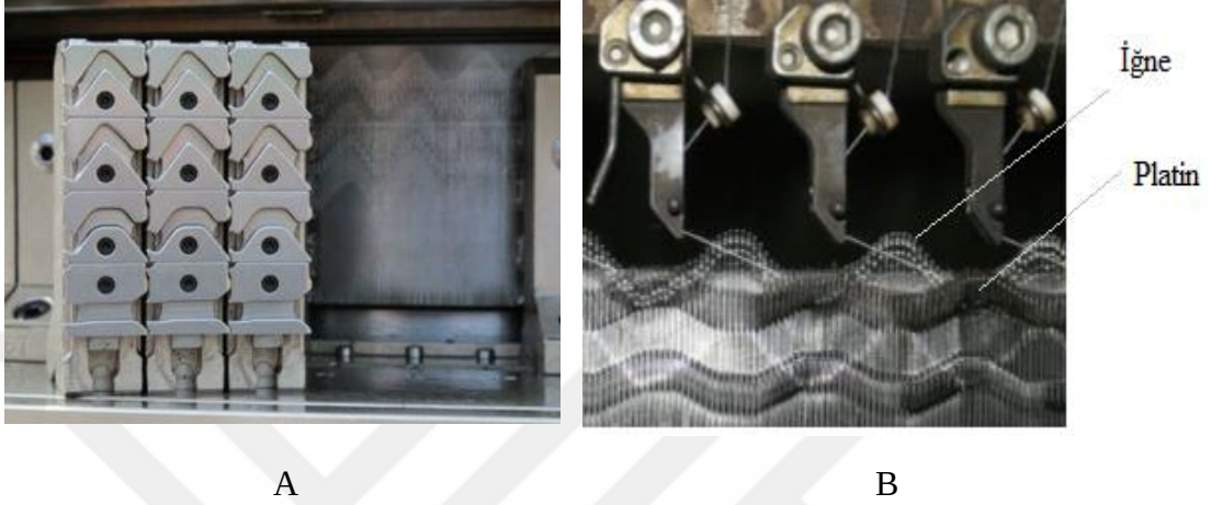
Şekil 2.33 : A- Yuvarlak örme makinasında iğne kam profili ve B- İğne ve platinlerin örme esnasındaki pozisyonu [48, 49].
