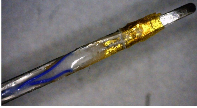
Şekil 3.14 : İğnenin pim bölgesine gerinim ölçer yapıştırılması.
