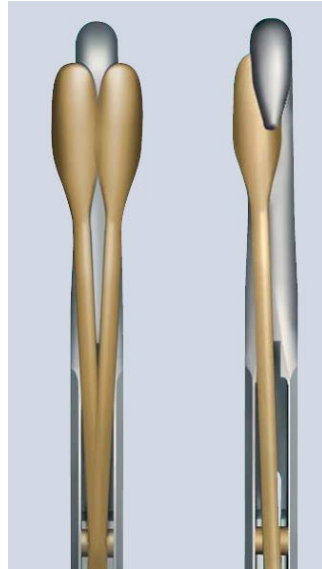
Şekil 2.7 : İğne dilindeki sapmalar ve kancanın altına kaymış iğne dili [1].
