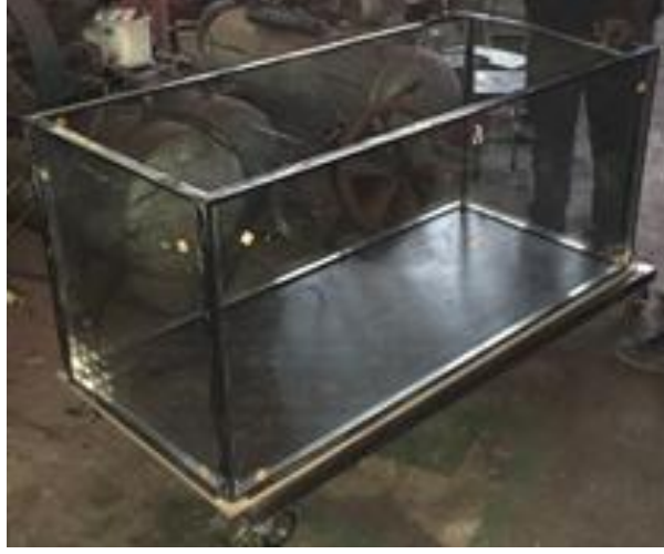
Şekil 3.26. Temperli Cam İle Oluşturulmuş Ses Kabini
