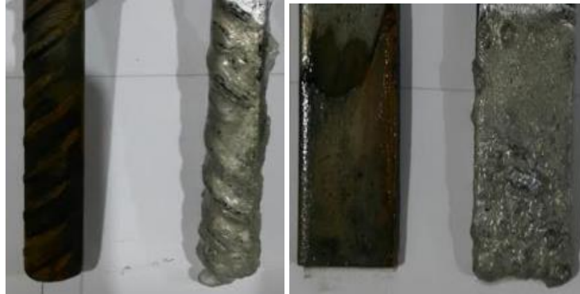
Şekil 4.8. Silindirik ve lama çelik numunelerin korozyon deneyinden sonraki görüntüleri
