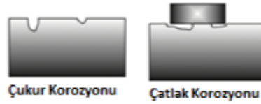
Şekil 2.20. Çukur korozyonu-Çatlak korozyonu (Topal 2016)
