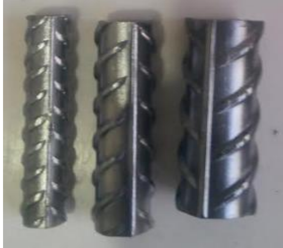
Şekil 3.1. Kaplama yapılacak olan silindirik çelik numuneler
