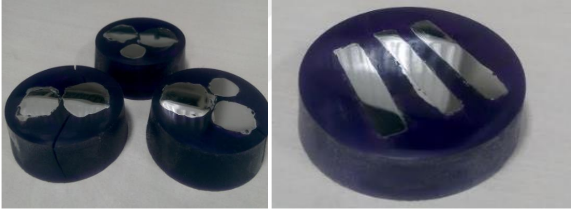
Őekil 4.1. Bakalite alınmıŐ nervrl silindirik ve lama elik numuneler
