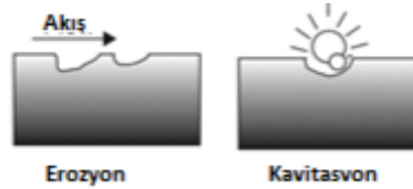
Şekil 2.24. Erozyon-Kavitasyon korozyonu (Topal 2016).
