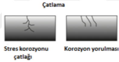
Şekil 2.26. Gerilmeli(stres) korozyonu-yorulmalı korozyon (Topal 2016)
