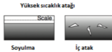
Şekil 2.27. Soyulma-iç atak korozyonu (Topal 2016)
