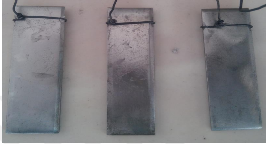
Şekil 3.2. Kaplama yapılacak olan St-37 az karbonlu lama çelik numuneler
