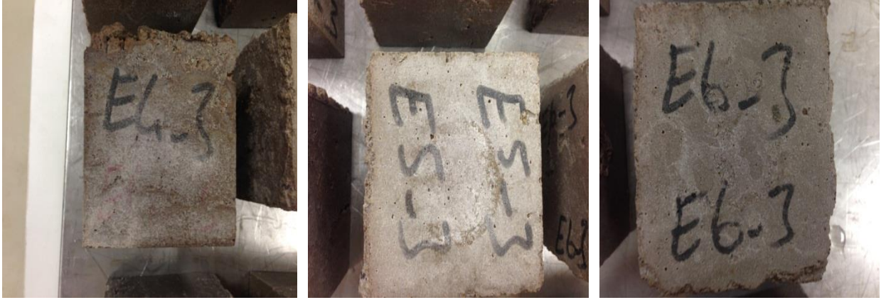
Şekil 4.41. Asit deneyi sonrası E4, E5 ve E6 nolu numunelerin fiziksel değişimi
