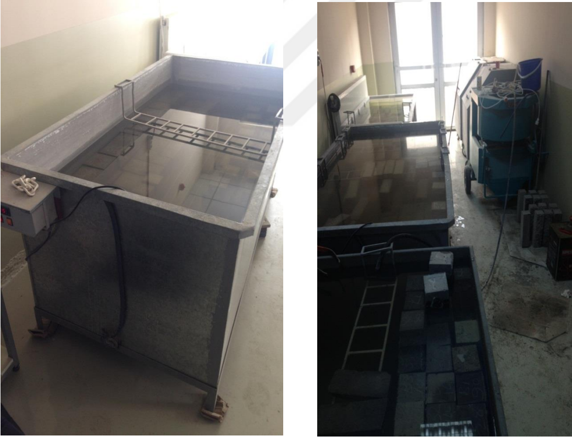
Şekil 3.2. Kür havuzları ve su kürü uygulanan numuneler
