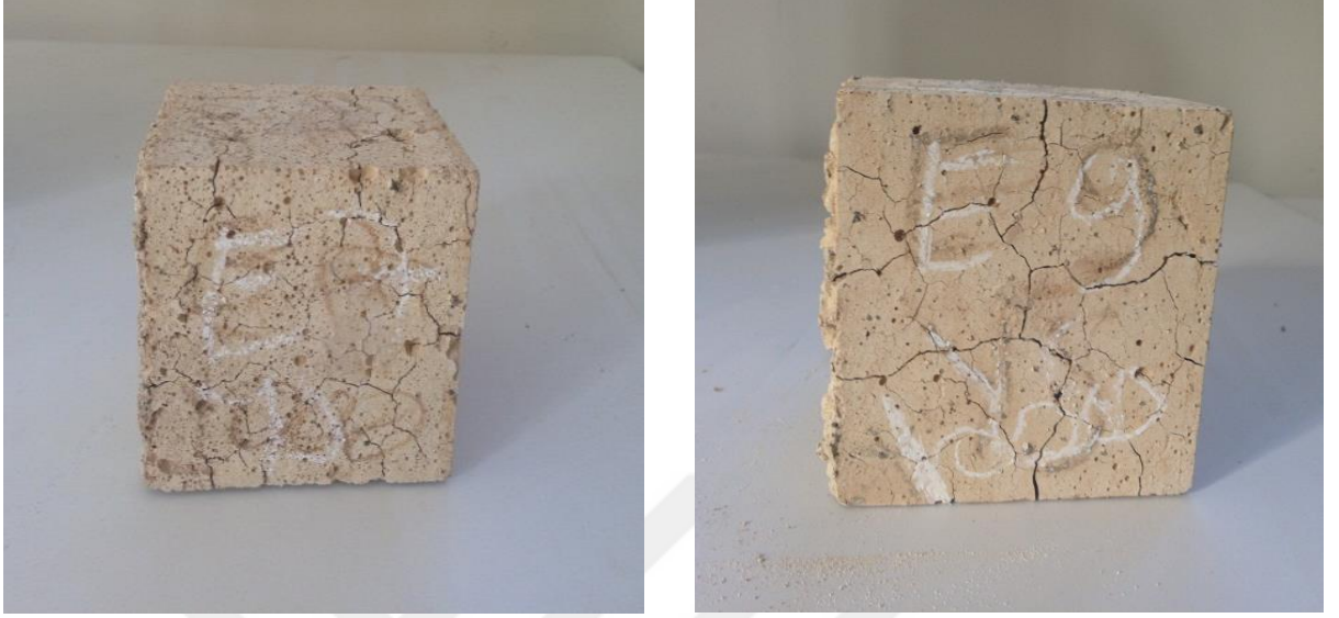
Şekil 4.20. 1000°C sonrasında numune yüzeylerinde meydana gelen yoğun makro çatlaklar
