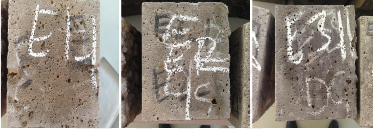
Şekil 4.32. Donma-çözünme deneyi sonrası E1, E2 ve E3 nolu numunelerin fiziki görünüşleri
