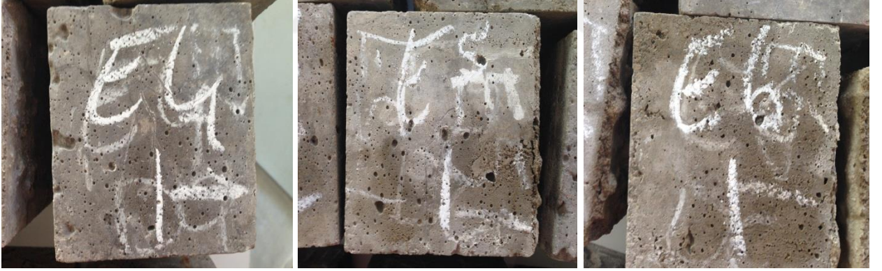
Şekil 4.33. Donma-çözünme deneyi sonrası E4, E5 ve E6 nolu numunelerin fiziki görünüşleri
