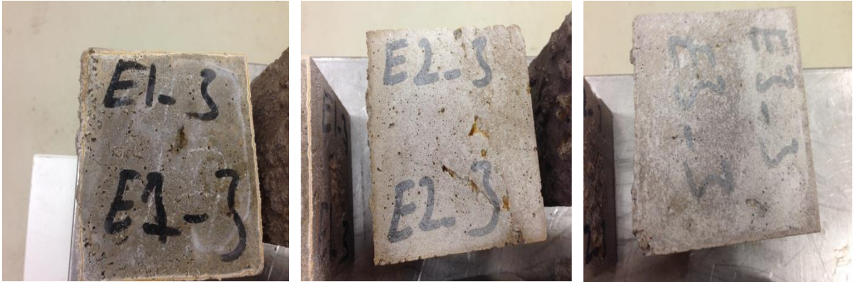
Şekil 4.40. Asit deneyi sonrası E1, E2 ve E3 nolu numunelerin fiziksel değişimi
