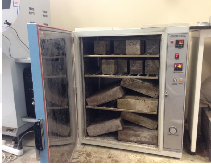
Şekil 3.14. Islanma-kuruma deneyinde kullanılan otomatik kontrollü etüv
