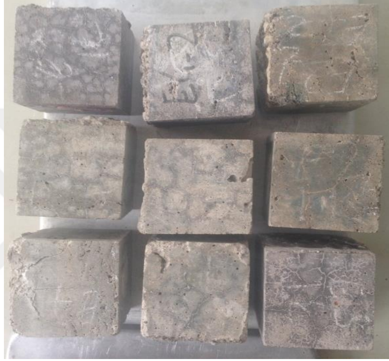
Şekil 4.46. KYHB numunelerin tuzlu su deney sonrası kristal tuz oluşumu ve yüzeyde çatlakların şekli.
