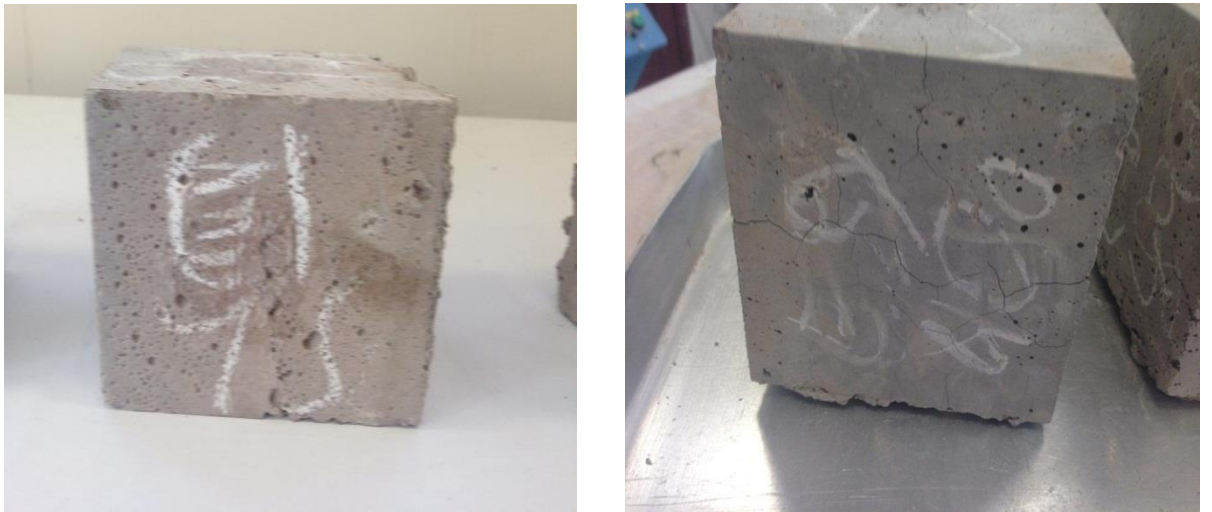
Şekil 4.17. 200 °C (soldaki resim) ve 400°C (sağdaki resim) sonrasında numune yüzeylerinde meydana gelen seyrek mikro çatlakların görünümü
