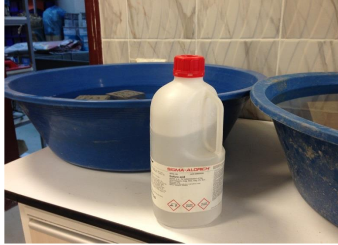
Şekil 3.12. Asit dayanıklılık deneyi düzeneği
