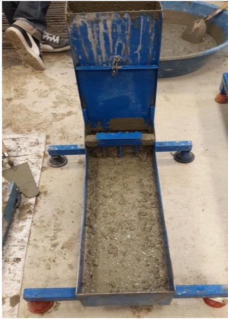
Şekil 3.5. L-kutusunun tipik tasarımı ve boyutları [38]
