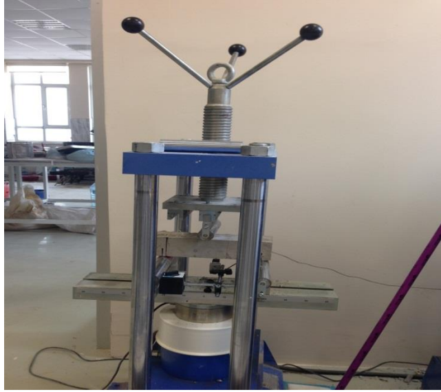
Şekil 3.7. Yük kontrollü eğilmede çekme deney aleti
