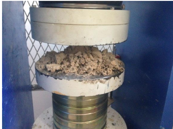
Şekil 4.21. 1000°C sonrasında kırılmaya tabi tutulan bir numunenin içyapısı
