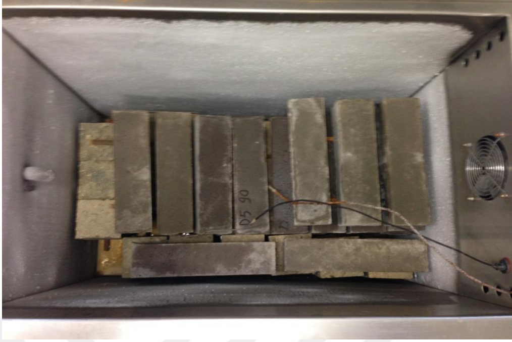
Şekil 3.11. Donma-çözünme deneyinde kullanılan deney aleti
