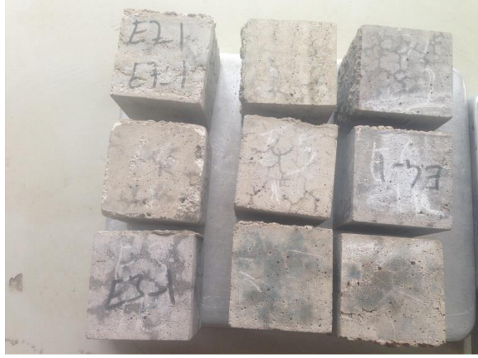
Şekil 3.16. Van Gölü suyunda Islanma-kuruma deneyi sonrası bazı numunelerin görünümü
