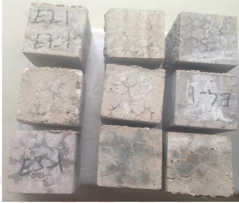
Şekil 4.49. KYHB numunelerin Van Gölü suyu sonrası yüzeyde çatlakların şekli
