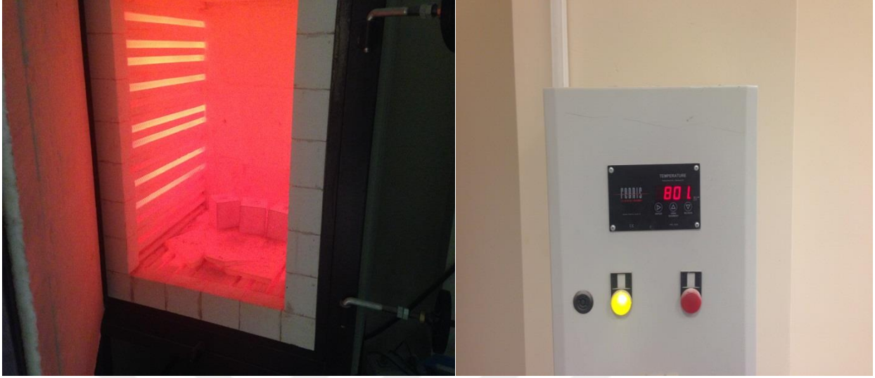
Şekil 3.10. Yüksek sıcaklık deneyinde kullanılan laboratuvar tipi yüksek sıcaklık fırını
