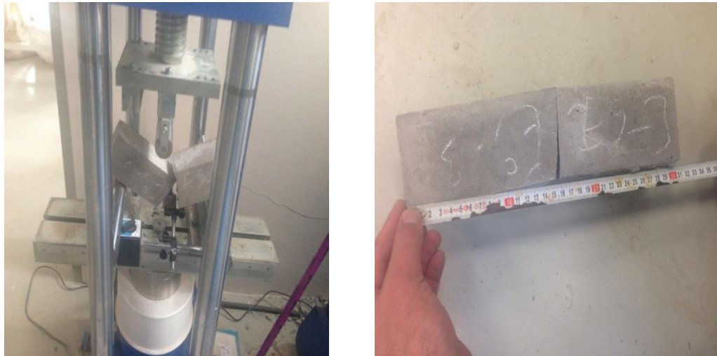
Şekil 4.16. Eğilme deney sonucu kırılma biçimi
