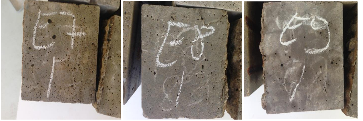
Şekil 4.34. Donma-çözünme deneyi sonrası E7, E8 ve E9 nolu numunelerin fiziki görünüşleri
