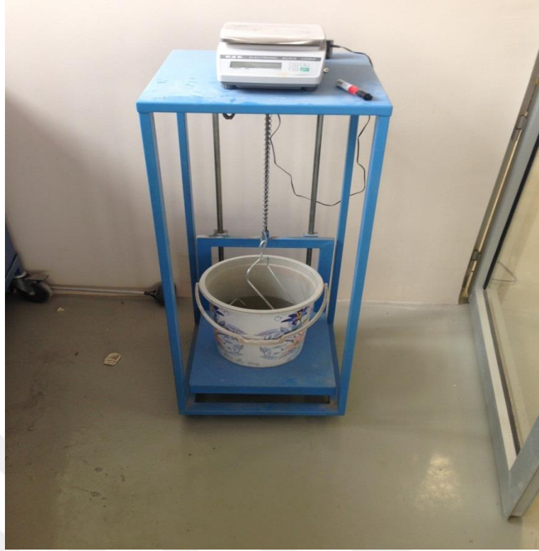
Şekil 3.9. Rölatif porozite deney düzeneği (Arşimet terazisi)
