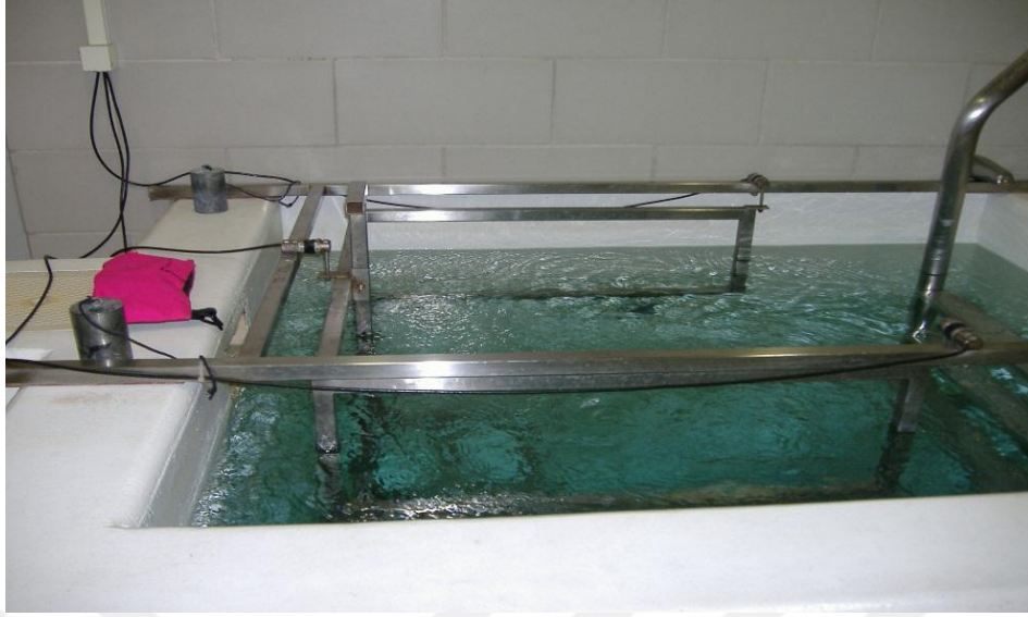
Şekil 2c. Hidrostatik Tartım Havuzu
