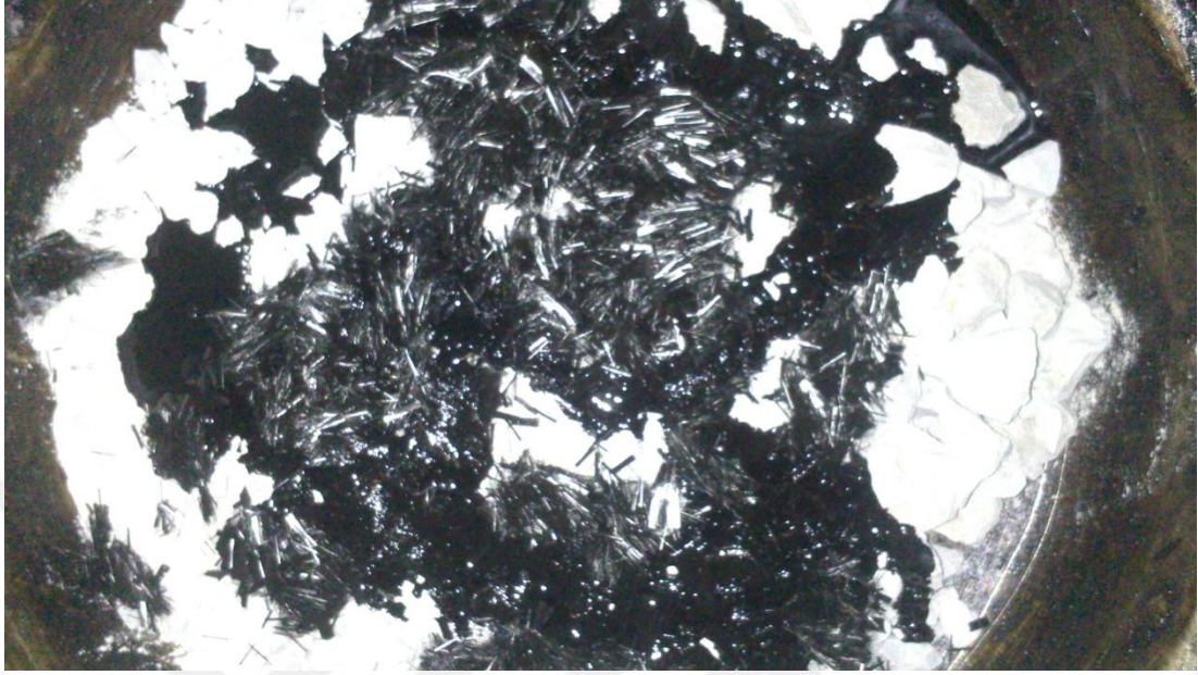
Şekil 4.6. Karbon Fiber, Bitüm ve Agrega Harmanlanması
