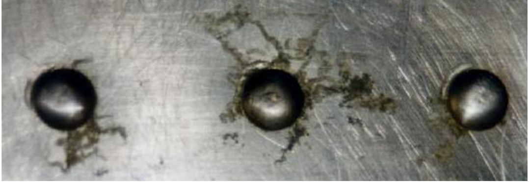
Şekil 2.27. İpliğimsi korozyona örnek
