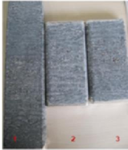
Şekil 3.2. Yaş boya kaplı lamaların taş çarpma ve tuzlu sis testinden sonra yüzey görüntüleri
