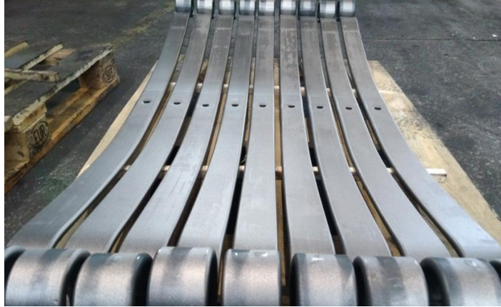
Şekil 3.6. Genellikle uygulanan yaprak yay yüzey kaplama aşamaları
