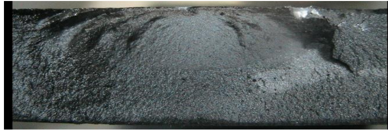
Şekil 4.9. Polimerik kaplı numune yaprak yayın hasarlı yüzeyine ait makro görüntü
