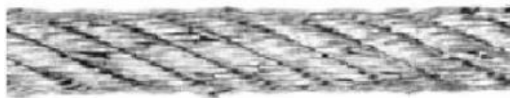
Figure 4.17 : Insufficient lubrication (Verreet & Ridge, 2005).
