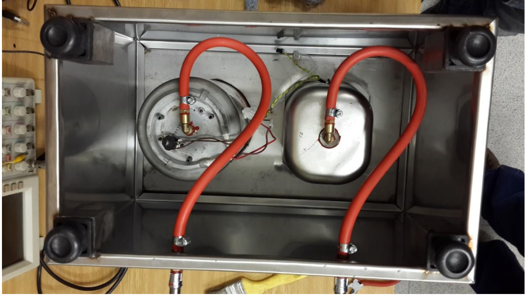
Şekil 4.10. Nükleer iz kazıma ünitesinin tahliye hattı
