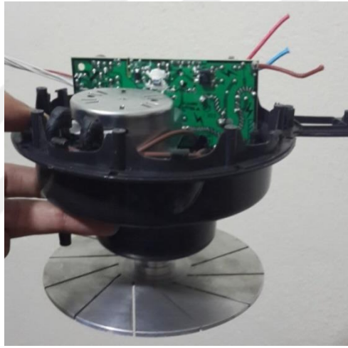
Şekil 4.8. Kapağa yerleştirilen motor ve elektronik kartı.
