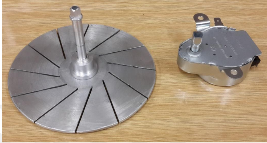
Şekil 4.6. Dönmeyi sağlayacak olan motor ve paslanmaz mil.
