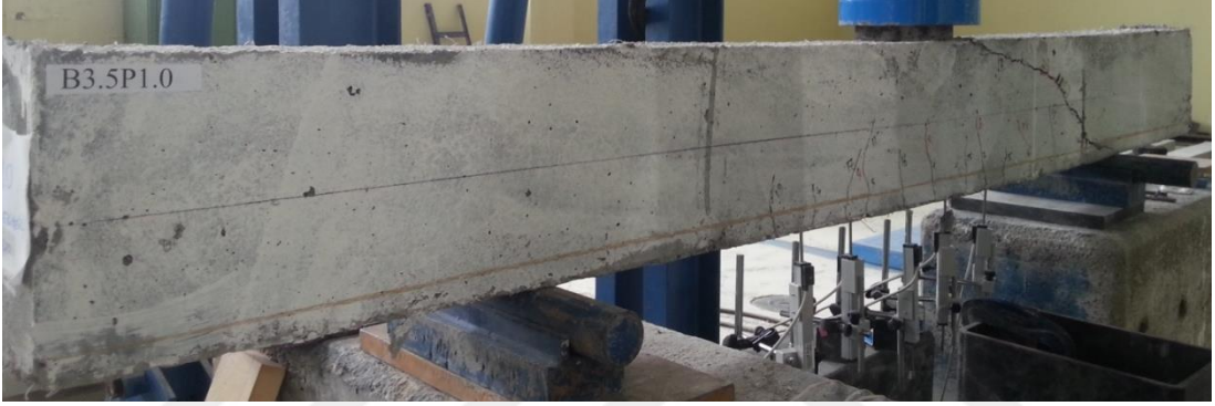
b) Güç tükenmesine ulaştığında B3.5P1.0 kirişi
