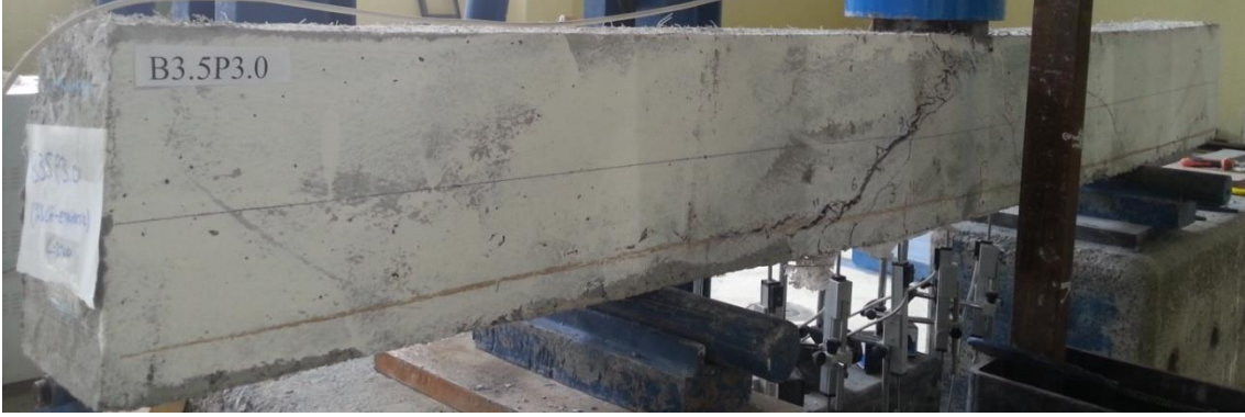
b) Güç tükenmesine ulaştığında B3.5P3.0 kirişi
