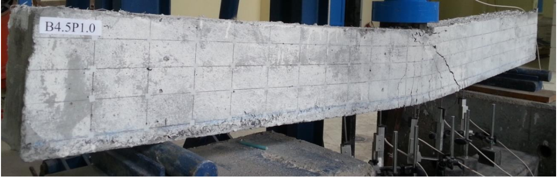
b) Güç tükenmesine ulaştığında B4.5P1.0 kirişi
