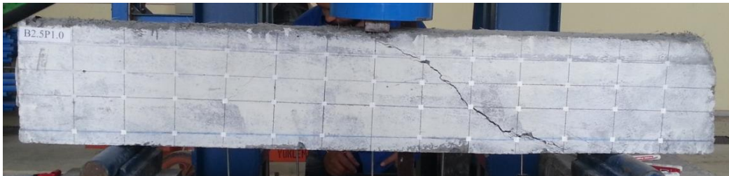
b) Güç tükenmesine ulaştığında B2.5P1.0 kirişi
