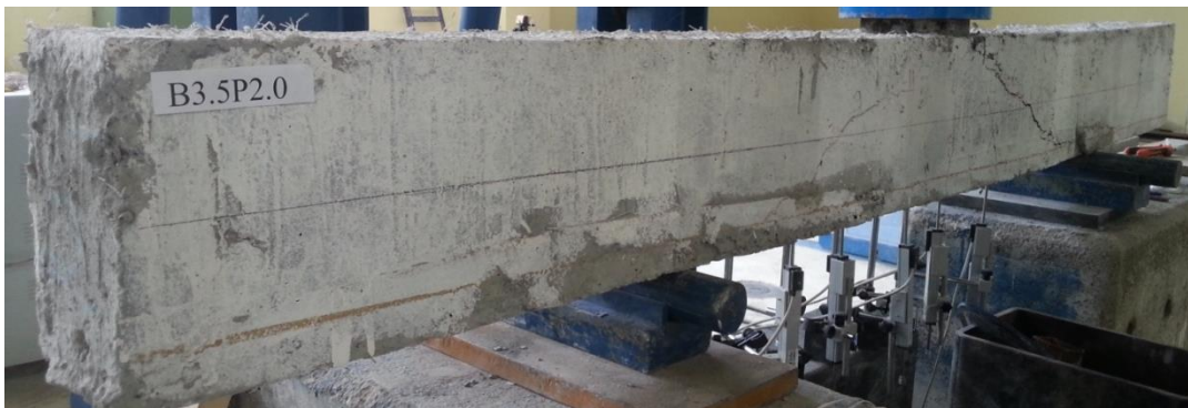
b) Güç tükenmesine ulaştığında B3.5P2.0 kirişi
