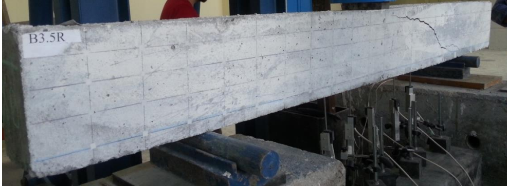
b) Güç tükenmesine ulaştığında B3.5R kirişi
