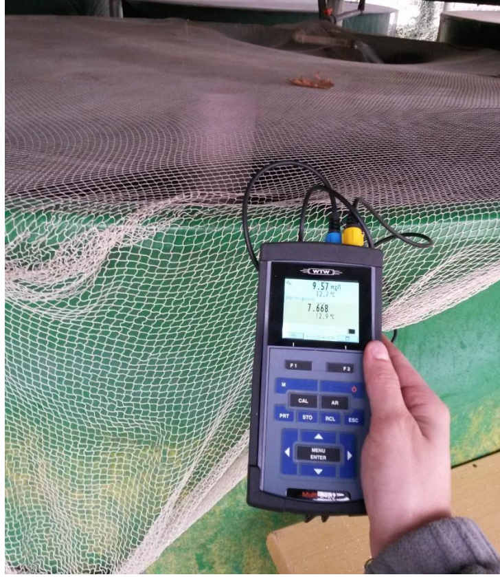
Şekil 3.7: Multiparametre ölçer ile sudaki sıcaklık, çözülmüş oksijen ve pH tespiti.
