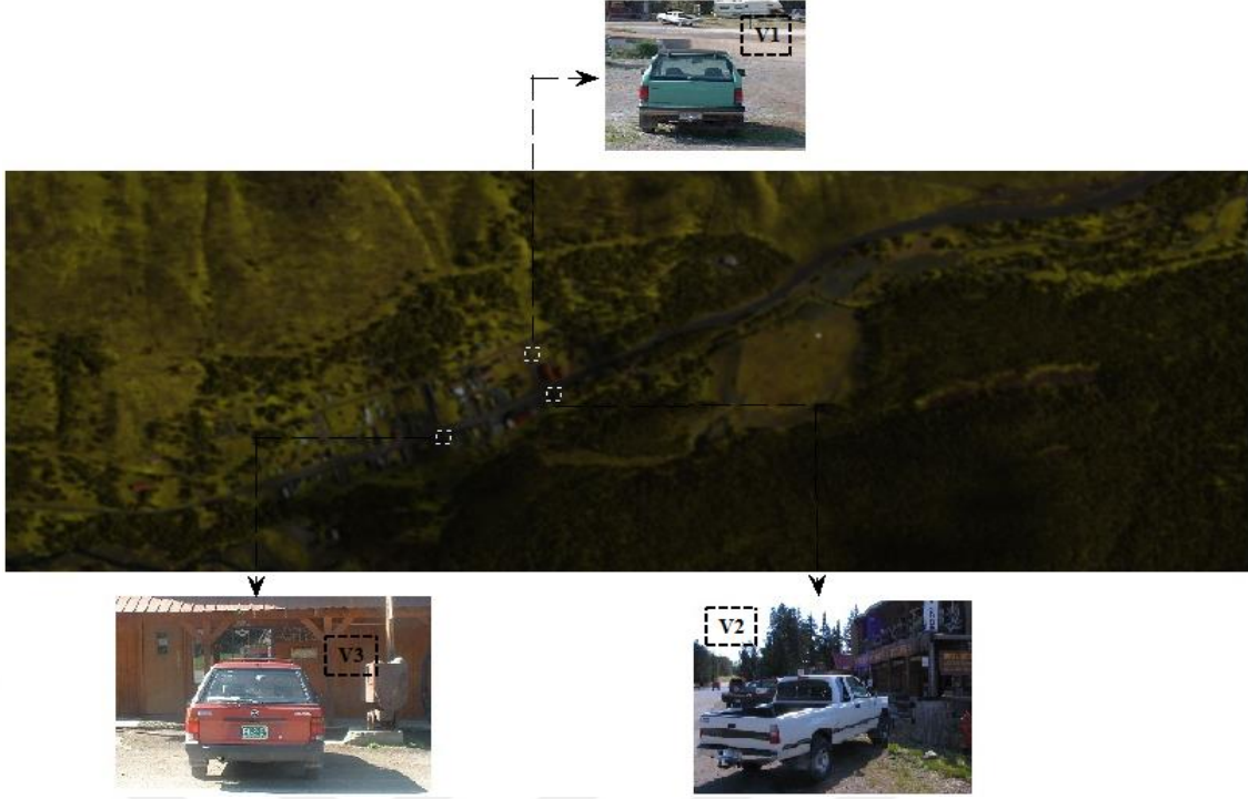
Şekil 3.10 HyMap hiperspektral verisinin bir kısmı ve V_1 , V_2 , and V_3 hedeflerine ait referans ilgi alanları ile doğrulama fotoğrafları. Hiperspektral küp {R:40, G:23, B:10} kanalları ile sahte renklendirilmiştir.
