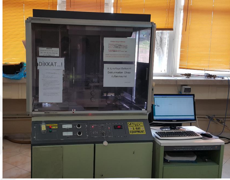
Şekil 4.12: Hacettepe Üniversitesi Fizik Mühendisliği Bölümü SNTG Laboratuvarındaki XRD difraktometresi.
