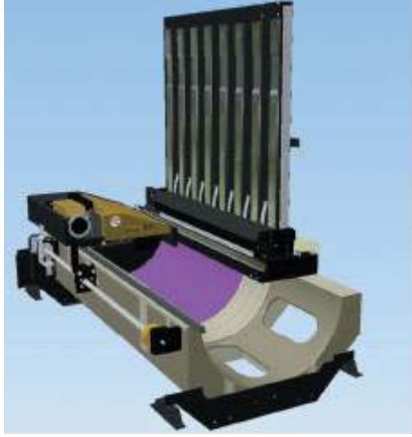
Şekil II.4 İç Tambur Sisteminin İçten Görünümü
