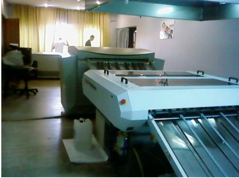
Şekil II.2 Dış Tambur CTP makinesi
