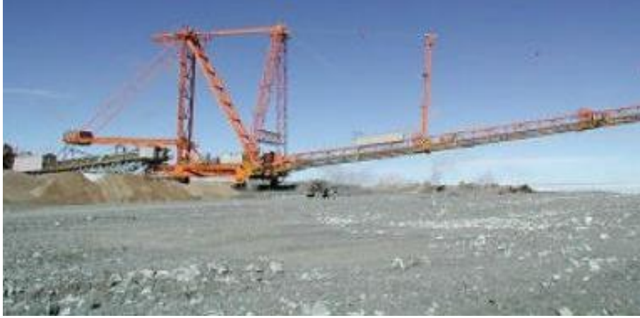
Şekil 4.13 Yarı mobil yayıcı çalışırken.
