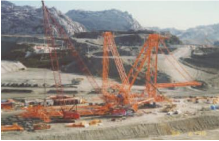
Şekil 4.14 Yayıcı taşınmak üzere sökülürken.
