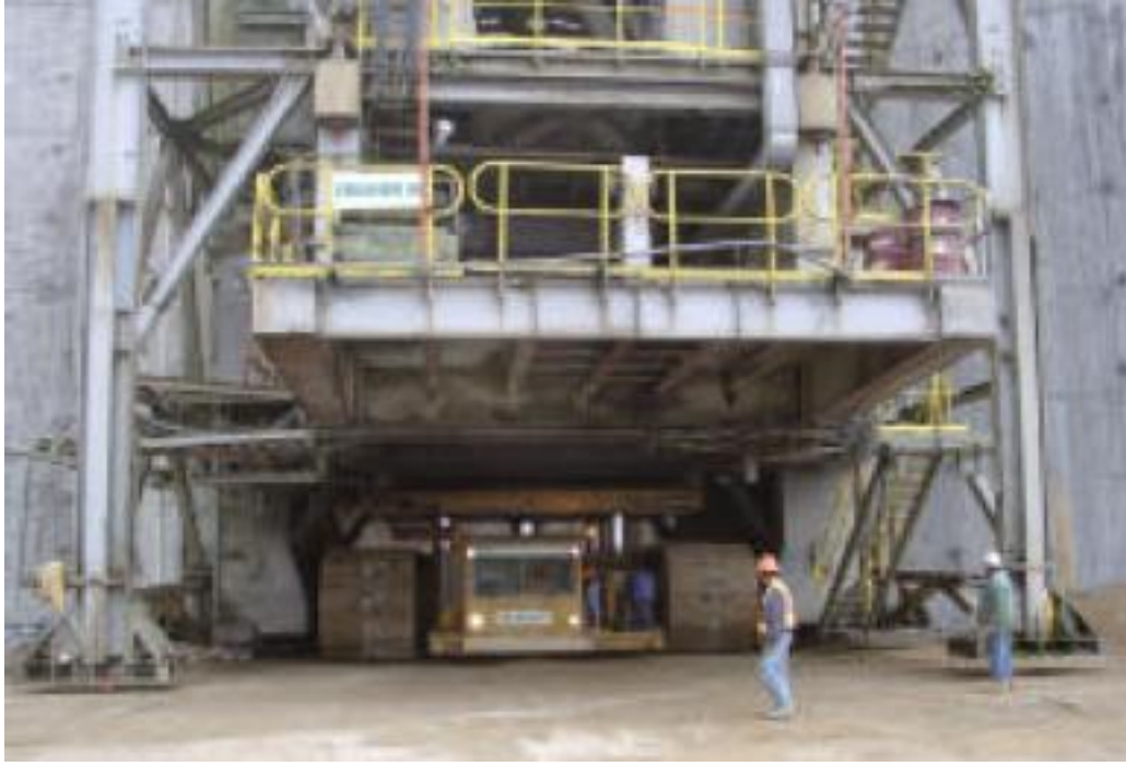
Şekil 4.9 8 No.lu kırıcının paletli taşıyıcı tarafından kaldırılması.
