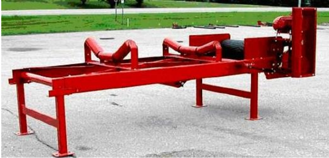
Şekil 3.9 Bir sabit bant konveyöre ait şasi sisteminin baş tarafının görünümü.
