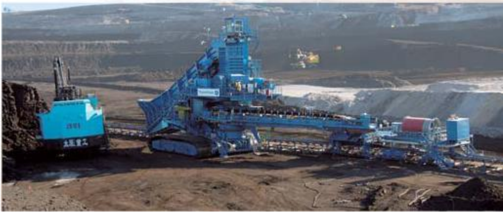
Şekil 3.2 Mobil kırıcı ile bant konveyör arasında bant arabasının çalışması.
