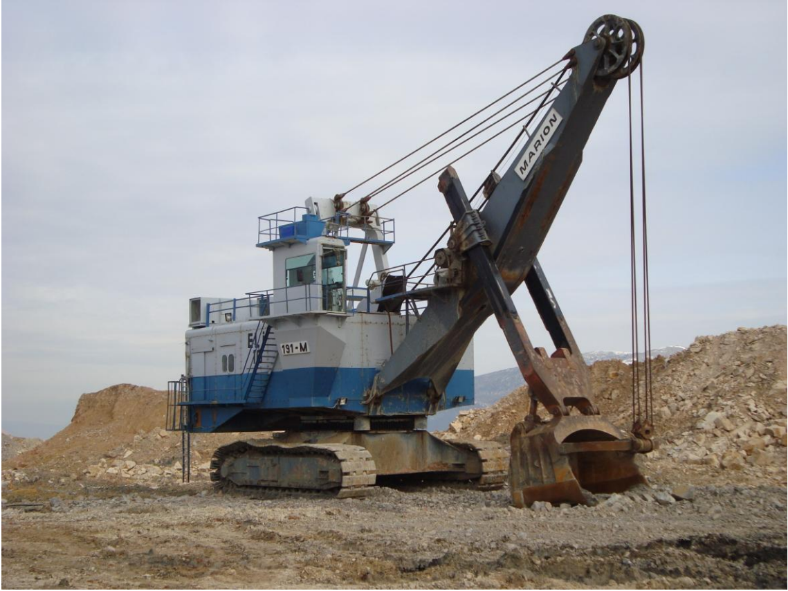
Şekil 3.6 15,3 m 3 (20 yd 3 ) Kepçe kapasitesine sahip halatlı ekskavatör
