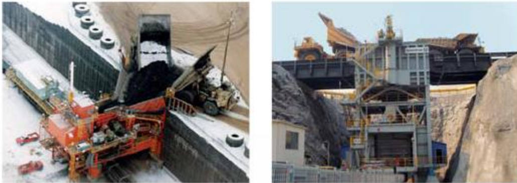
Şekil 3.5 Kamyonlar ile beslenen yarı mobil kırıcı tesisi.
