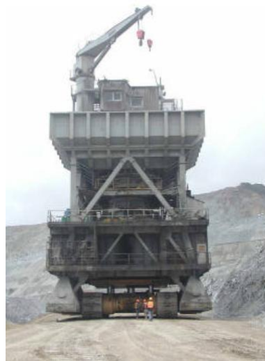
Şekil 3.3 Paletler üzerinde hareket eden bir yarı mobil kırıcı sistemi.
