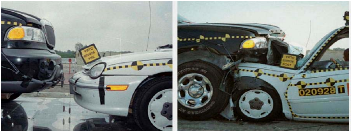
Şekil 3.12: Otomobil ile üst sınıf jipin kafa kafaya çarpışması sonucu jipin “tırmanması”
