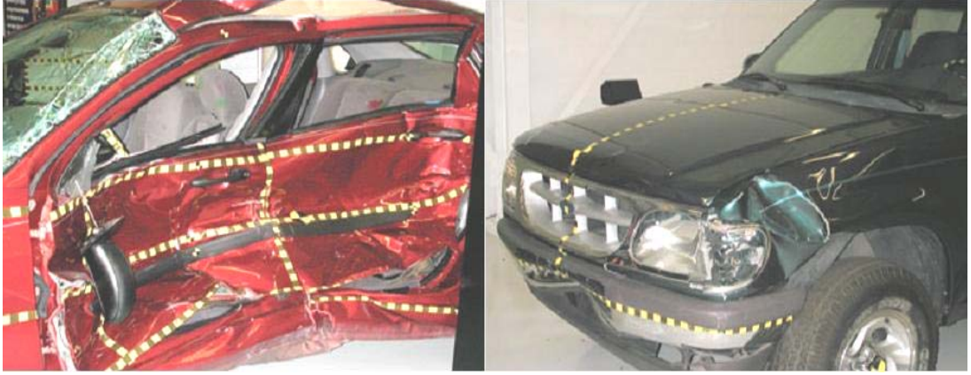
Şekil 3.23: SUV tipi taşıtın otomobile yandan çarpması sonucu oluşan hasar
