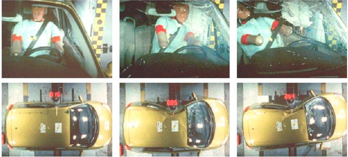
Şekil 3.21: Yandan çarpma esnasında sürücünün kinematiği
