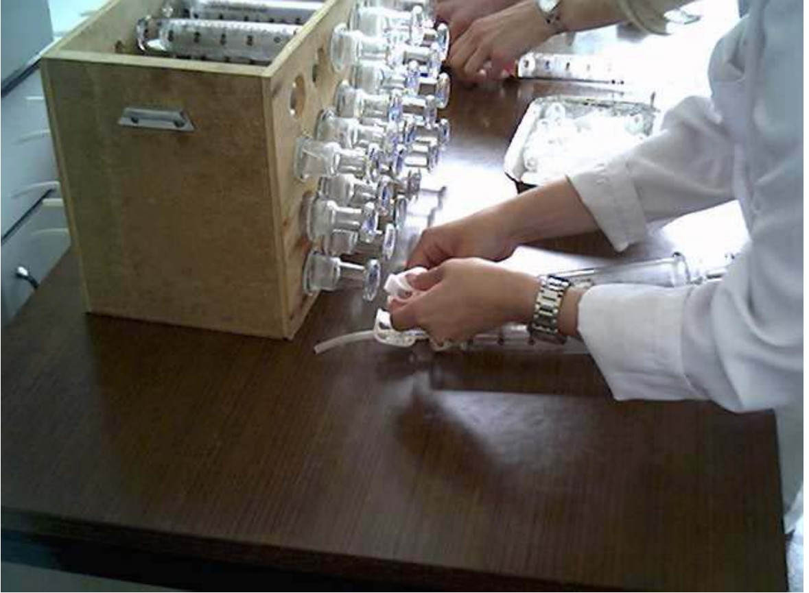
Şekil 3.7. Şırıngalara klips takılması
