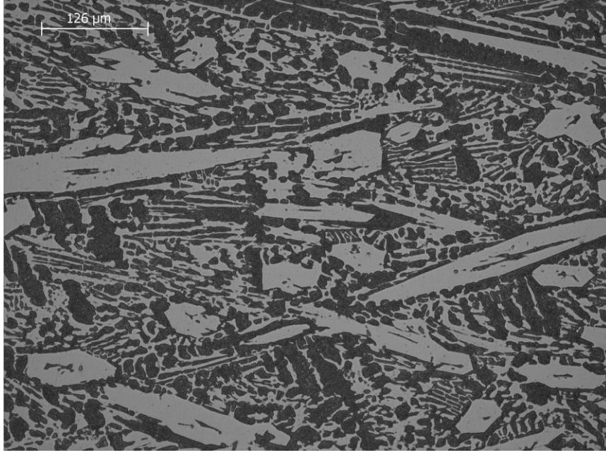
Şekil A. 21 : B08 numunesinin ısıt işlem sonrası mikroyapı görüntüsü (200X)
