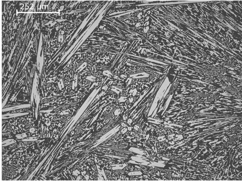
Şekil A. 18 : B06 numunesinin ısıı işlem ve temperleme sonrası mikroyapı görüntüsü (100X)
