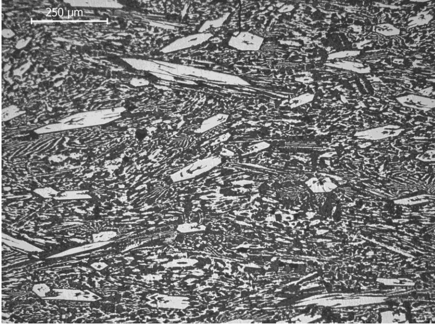
Şekil A. 7 : B015 numunesinin temperleme sonrası mikroyapı görüntüsü (100X)
