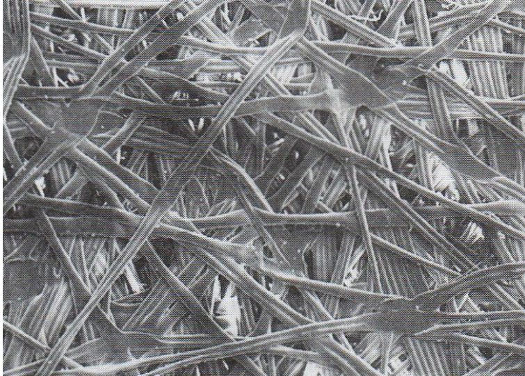
Şekil 3.6 : Örgüsüz geotekstil – Isıl birleşim (Koerner, 1998).
