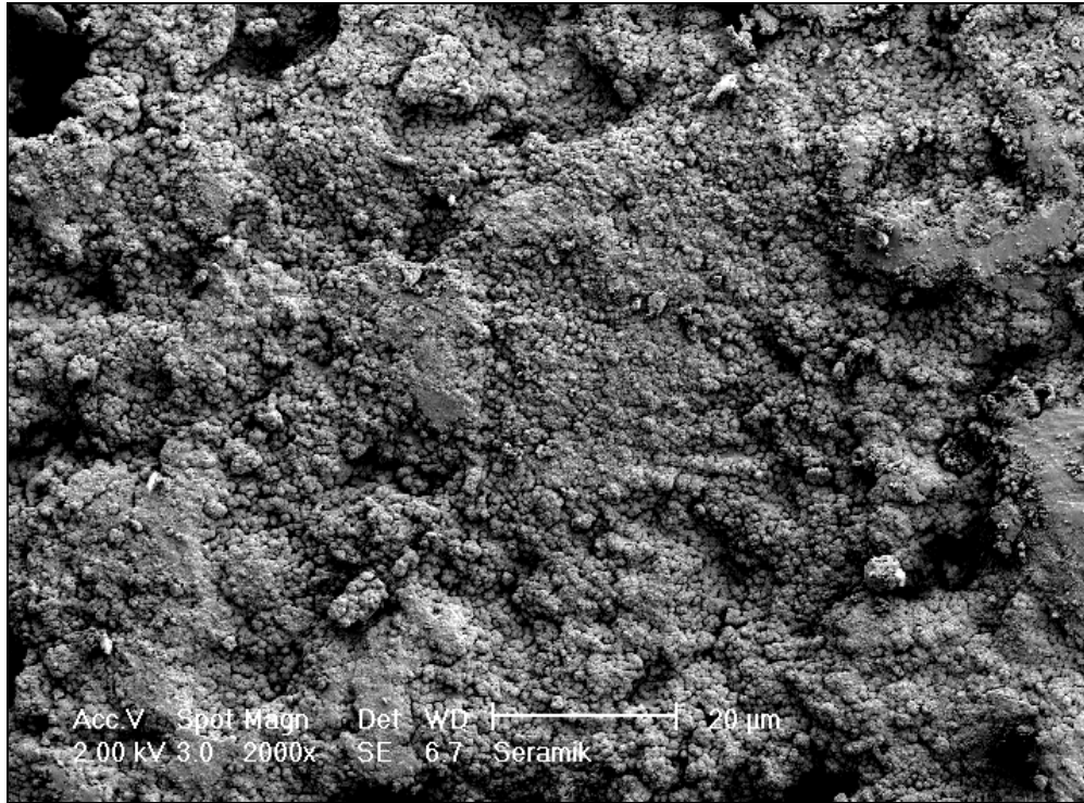
Şekil 4.8. Seramik destek malzemelerinin üzerinde ZnO ince filmin 2000 kat büyütülmüş SEM görüntüsü
