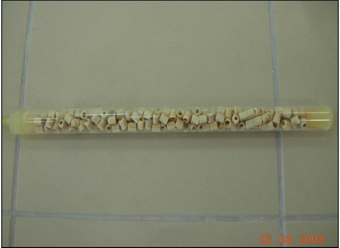
Şekil 3.17. İçi porselen boncuklarla dolu mikroreaktör
