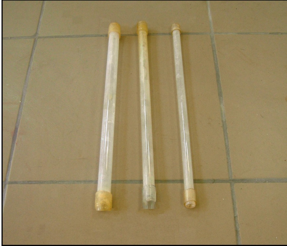
Şekil 3.16. İç duvarı İnce film ZnO ile kaplanmış kuvars cam boru tip reaktörler
