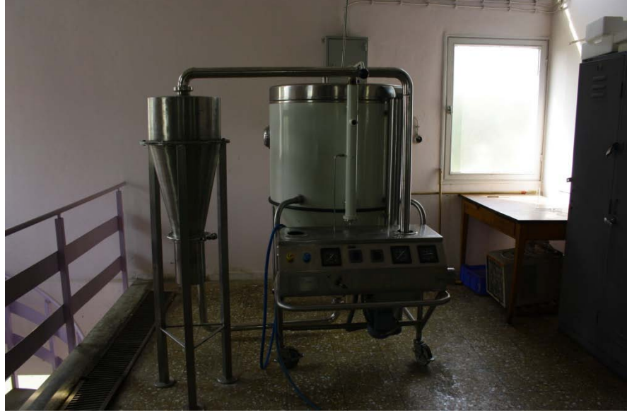
Şekil 3.2. Püskürtmeli Kurutma İşleminde Kullanılan Niro-Atomizör Mobile Minor Model Püskürtmeli Kurutucu.
