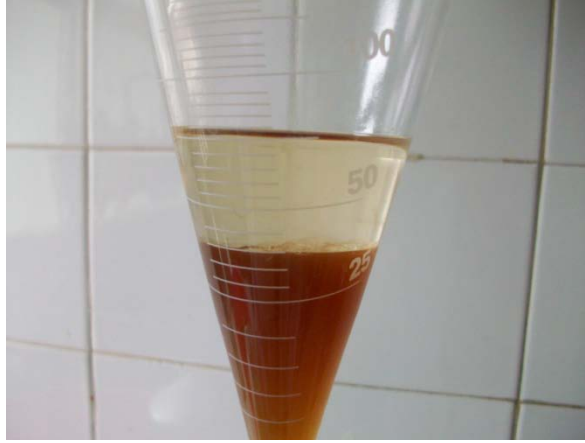
Şekil 3.6. Toplam Saponin Tayininin Bütanolle Yıkama Aşamasındaki Faz Ayrımı.
