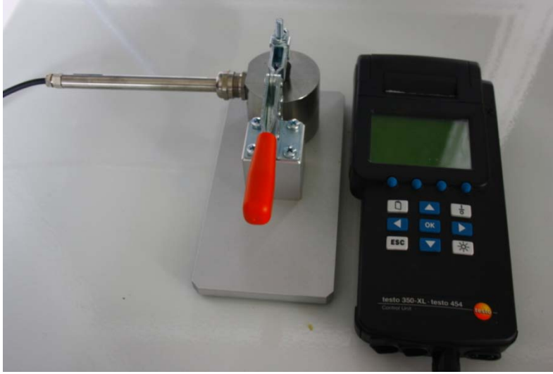
Şekil 3.5. Su Aktivitesi Tayininde Kullanılan Testo Electronics T350XL-454 Model Cihaz.
