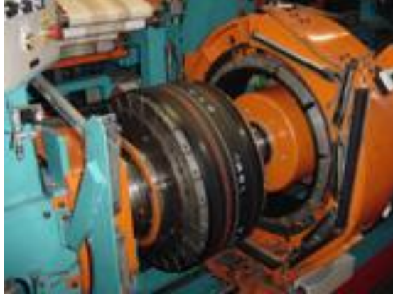
Şekil 2.5 Lastik bileşenlerinin montajı [İnternet 2]
