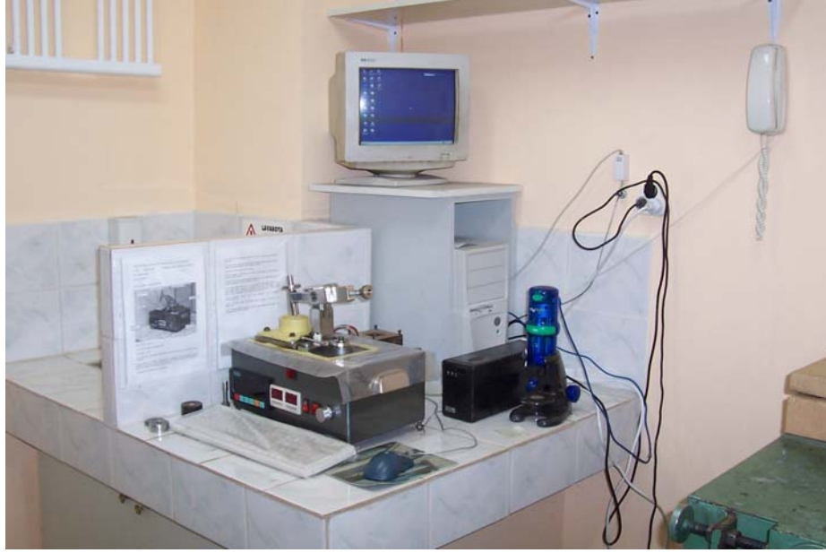
Şekil 6.7: İleri-geri aşınma deney düzeneği.
