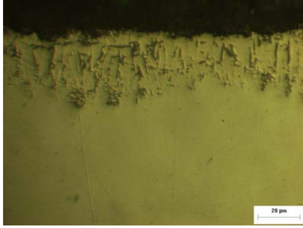
Şekil E.11: AISI 5140 borlanmış deney numunesi kesit görüntüsü -800x .
