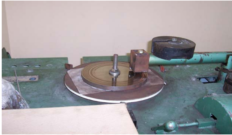
Şekil 6.4: Metal-metal aşınma deneylerinde disk üstünde pim deney düzeneği.
