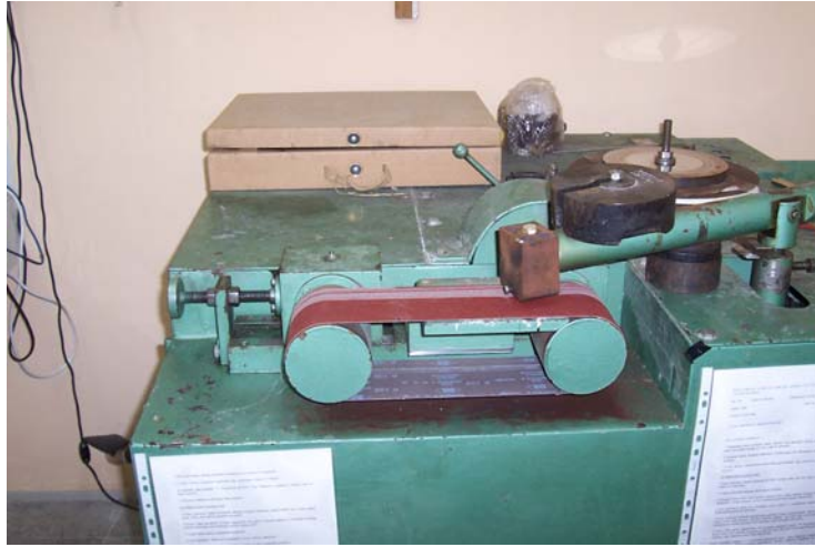
Şekil 6.5: Metal-abrazif aşınma deney düzeneği.
