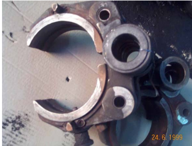
Şekil 4.17: Kullanılmış ve hurdaya ayrılmış AISI 420 kalıp kolu[49].
