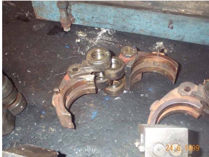
Şekil 4.15: Aşınma ve korozyona uğramış durumdaki kullanılmış bir kalıp kolu[49].
