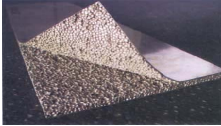
Şekil 2.6. Alüminyum Köpük Panel. Alman yedek parça firması Wilhelm Karmann ve Berlin'deki Fraunhofer Enstitüsü'nün geliştirdiği alüminyum köpük sandviç parçalardan biri. İki alüminyum tabaka arasında köpüklenmiş alüminyum göbekten oluşan düz bir sandviç panel. Bu teknolojiye herhangi bir katkı kullanmaksızın daha karmaşık şekiller de üretmek mümkündür.
