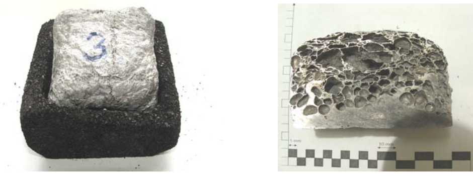
Şekil 6.3. Grafit kalıpta oluşturulan Alüminyum köpük malzeme ve kesiti
