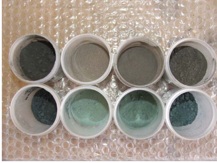
Şekil 6.2. Isıl işlem görmüş TiH_2 tozlarının renk değişimi
