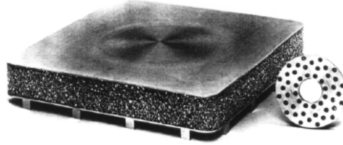
Şekil 1.7. Hafif kompozit ayna yapımında kullanılan DUOCEL köpüğü - ERG
