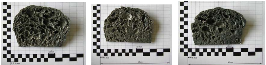
Şekil 6.12. 750 °C'de, 2% TiH 2 ve 20% SiC takviyeli , 8dk, 10 dk., 12 dk.bekletilmiş numuneler, \rho_1= 0,456 , \rho_2= 0,395 , \rho_3= 0,368
