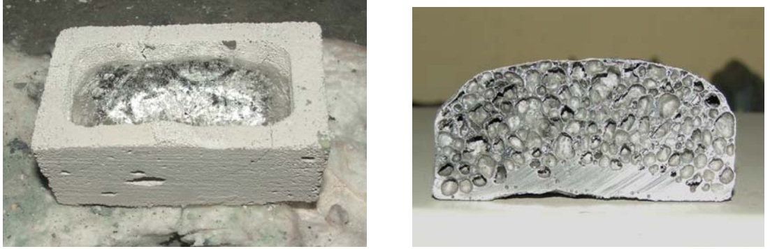
Şekil 6.4. Gaz beton kalıpta oluşturulan alüminyum köpük malzeme ve kesiti
