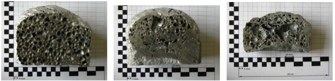
Şekil 6.11. 750 °C'de, 1,5% TiH 2 ve 20% SiC takviyeli , 8dk, 10 dk., 12 dk.bekletilmiş numuneler
