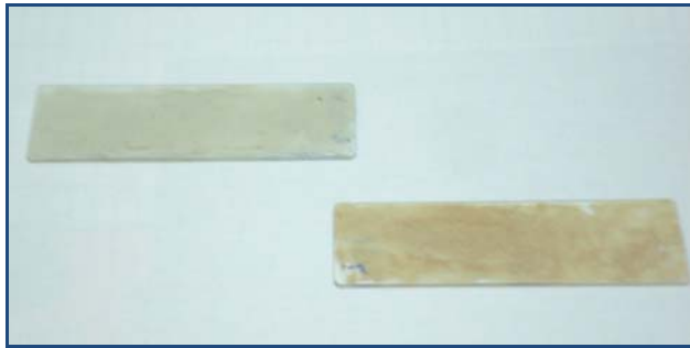
Şekil 3.22. Lam üzerine yerleştirilmiş kil örnekleri
