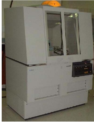
Şekil 3.28. X-Işınları Difraksiyonu (XRD) sisteminin görünümü
