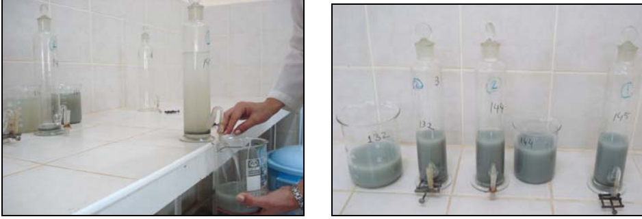
Şekil 3.21. Toprak örneklerinin kum, mil ve kil kümelerine ayrılması
