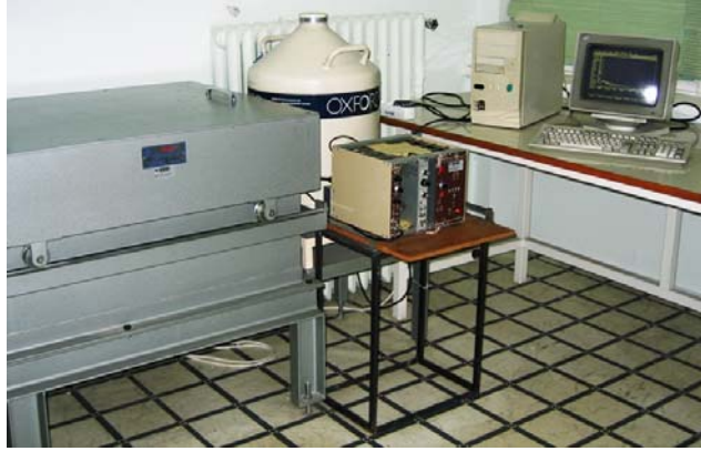
Şekil 3.26. HPGe spektrometre sisteminin görünümü
