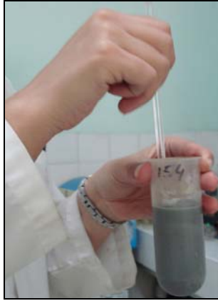
Şekil 3.19. Serbest demir oksitlerinin topraktan uzaklaştırılması
