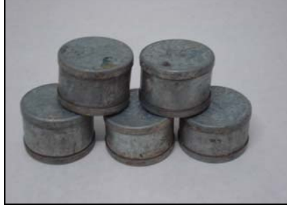
Şekil 3.24. 100 \text{ cm}^3 hacimli çelik silindirler
