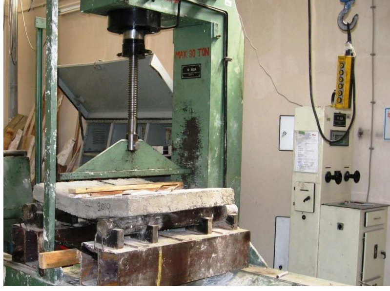
Şekil 4.12. 9Ø10 donatılı tek çatlaklı plak.
