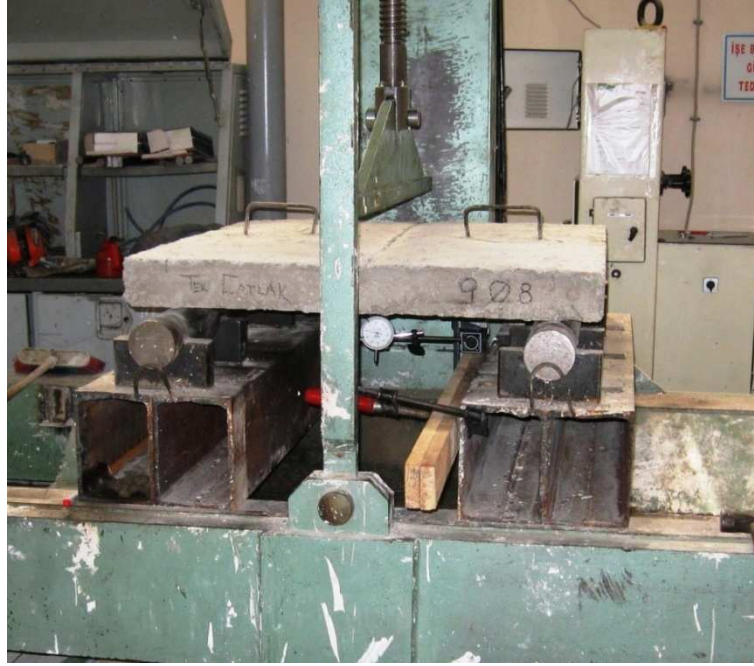
Şekil 4.10. 9Ø8 donatılı tek çatlaklı plak.
