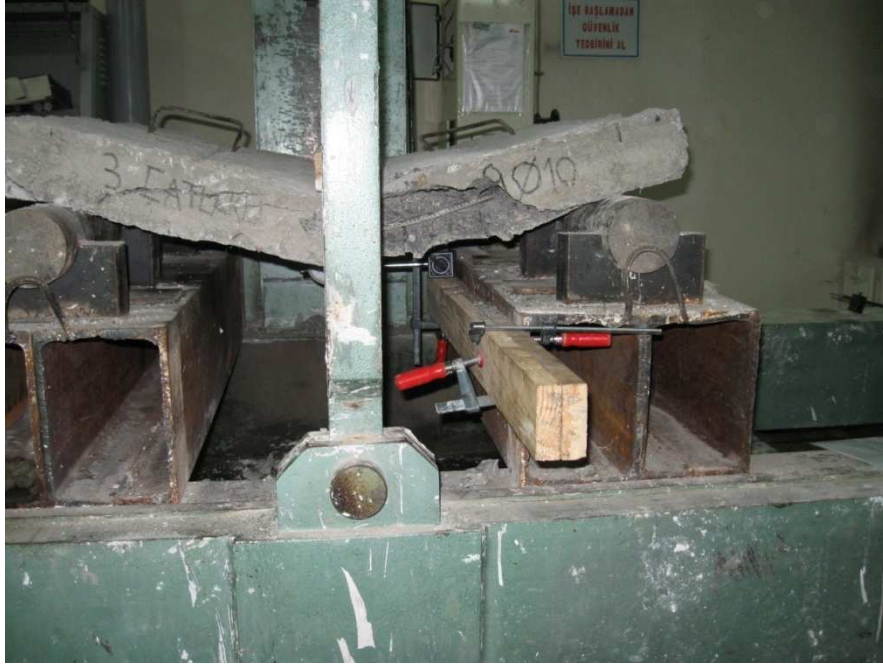
Şekil 4.16. 9Ø10 donatılı üç çatlaklı plak.
