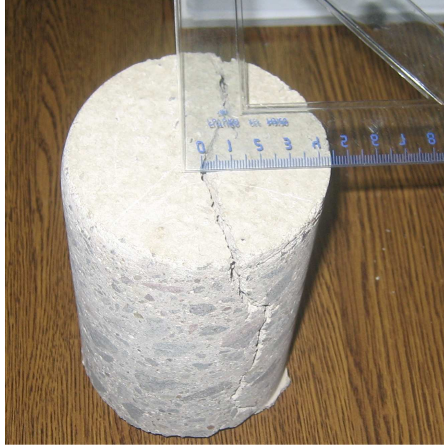
Şekil 4.1. Döşeme karot numunesi.
