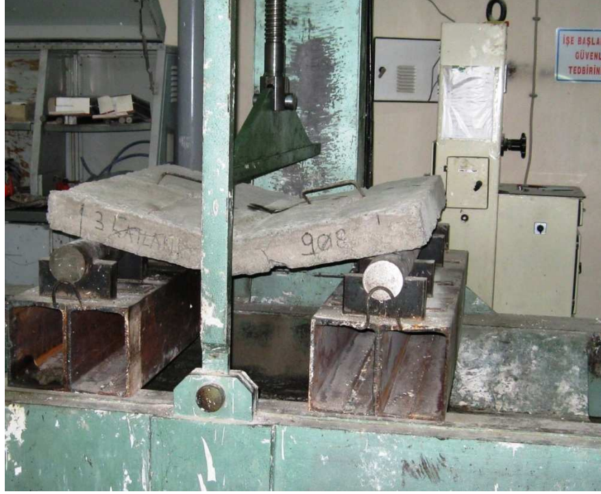
Şekil 4.14.9Ø8 donatılı üç çatlaklı plak.
