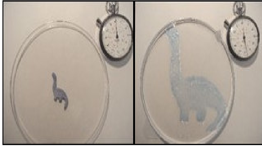
Şekil 2.7: SPH’in su içinde tamamen sismesi (~ 30 saniye)
