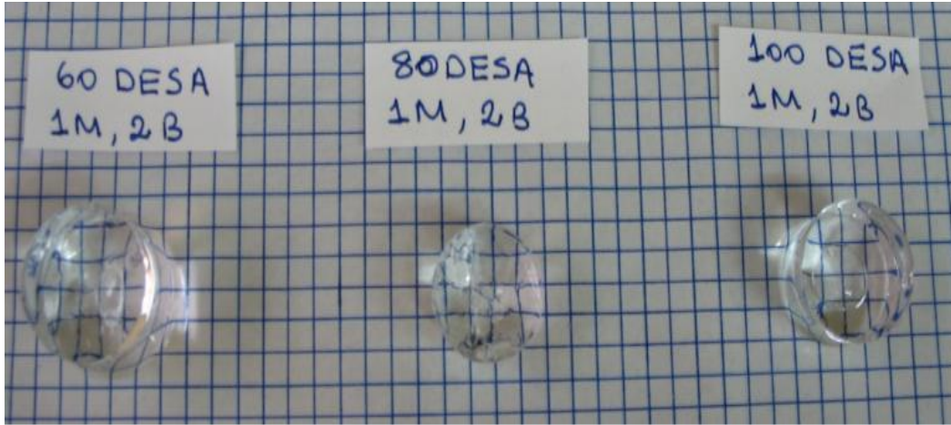
Şekil 4.2: Gözenek oluşturunusuz %2 NMBA ile hazırlanmış, şişmiş DMAEMASA homopolimeri ve kopolimerleri
