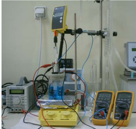
Şekil 3.2: Elektrokimyasal Cu-Sn tozu üretimi deney seti
